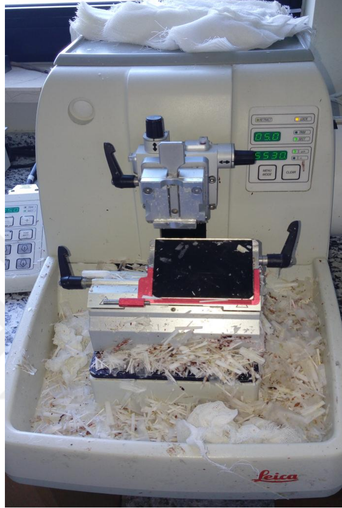
Resim 9: Histopatolojik incelemede kullanılan; Mikrotom cihazı: Leica RM 2245 (Germany)
