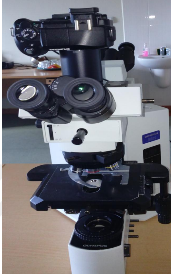
Resim 10: Histopatolojik incelemede kullanılan; Işık mikroskobu ve entegre fotoğraf makinesi sistemi: Olympus, BX51 (Japan)
