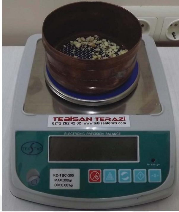
Şekil 17. Elek ve üzerindeki parçalanmış test materyal hassas terazide tartılma aşamasında
