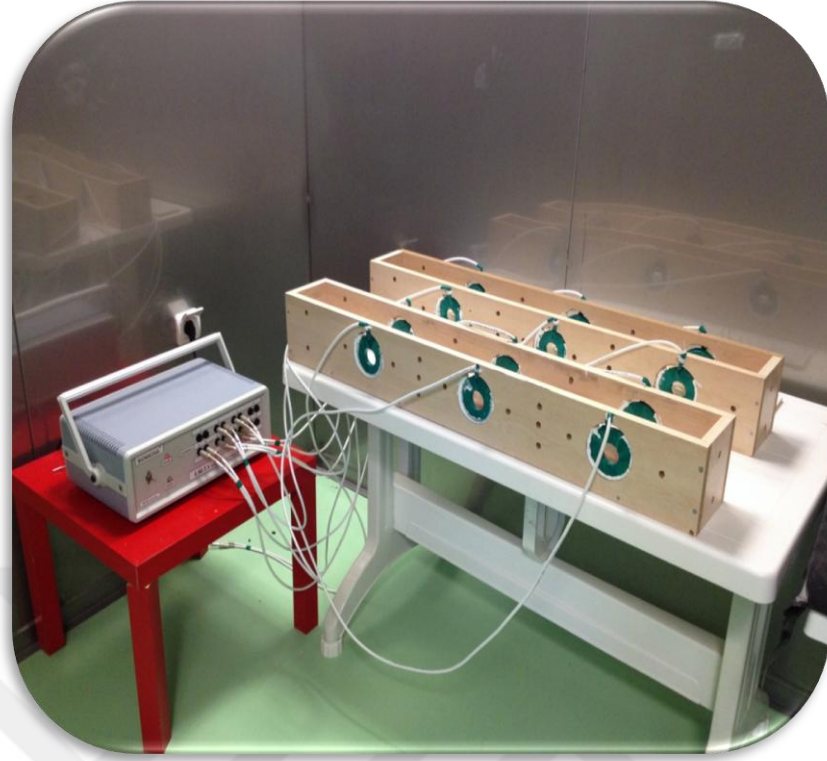
Resim 15. Darbeli Elektromanyetik Alan Cihazı, Bobinlerin Yerleştirildiği Düzenek ve Manyetik Alan Odası
