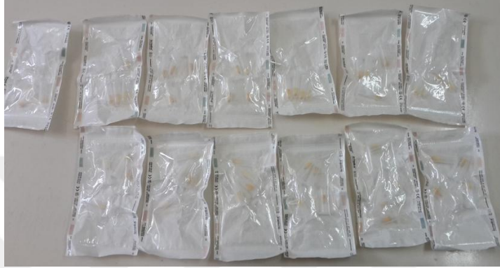
Resim 3. Örneklerin otoklava girmeden önce poşetlenmesi ( Bir sterilizasyon poşetinin içerisinde 4 veya 5 tane eppendorf bulunmaktadır.)
