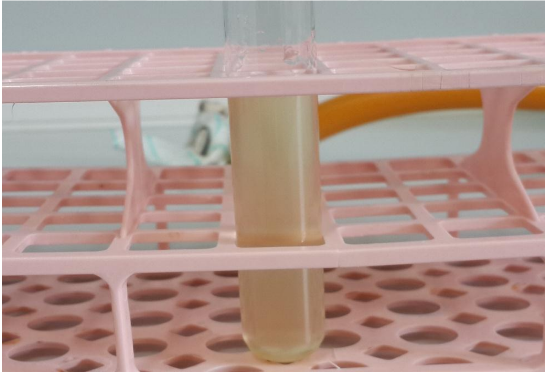
Resim 14. Pilot çalışmada silikona gömülmüş bulanıklık testi sonrası steril olmadığı gözlemlenen örneklerden biri
