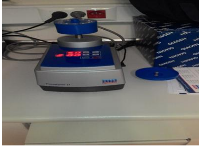
ekil 9. Çalı mada dokuların parçalanması için kullanılan parçalayıcı (Tissue Lyser).
