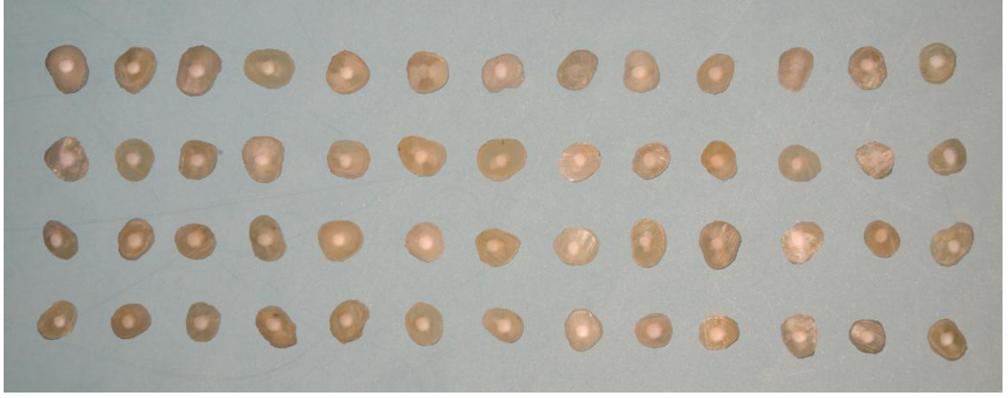
Resim 12b. 3 mm lik kök ucu dolgularının orta 1 \pm 0,05 mm'lik kısmından elde edilen dentin diskleri.
