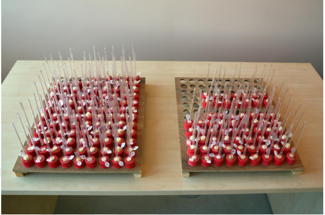
Şekil 8b. Örneklerin yerleştirildiği glikoz penetrasyon düzenekleri
