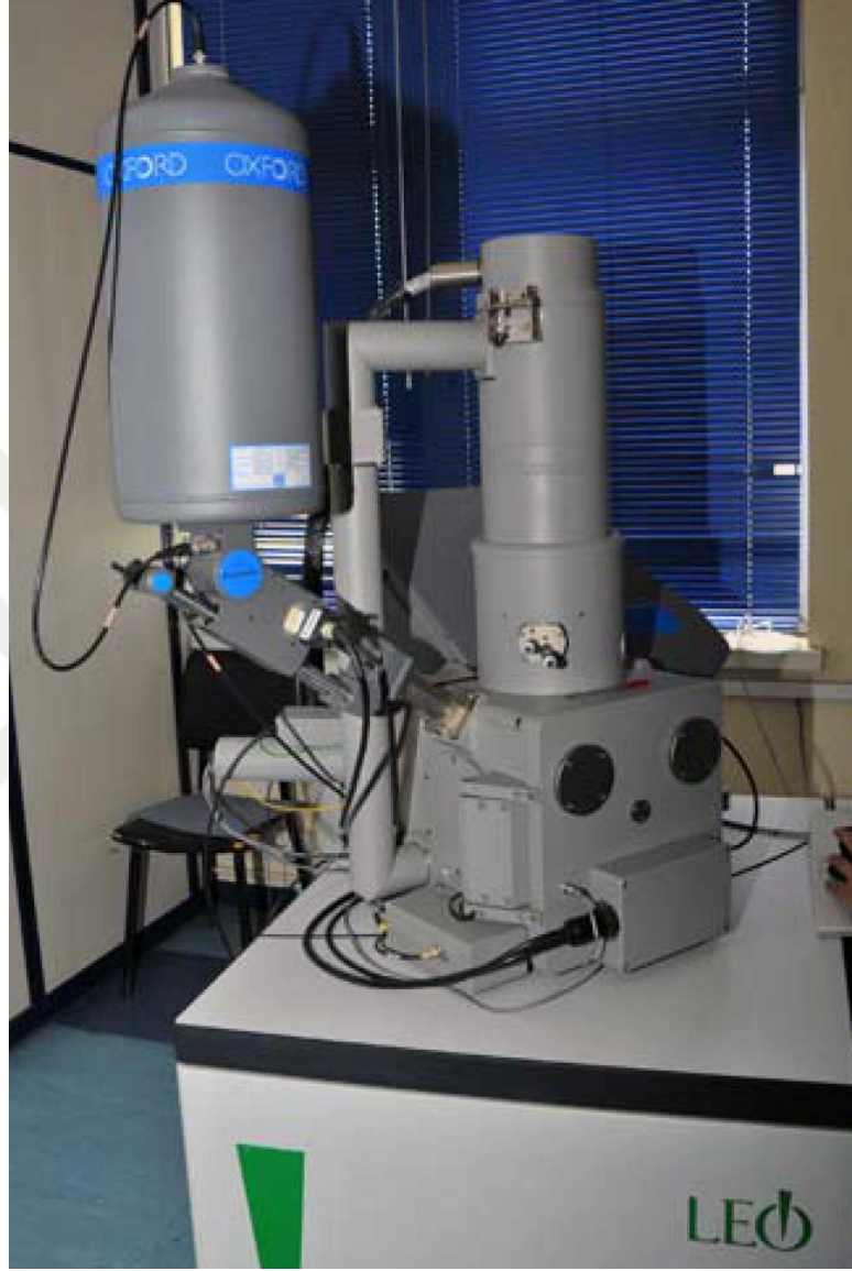
Resim 15. Dentin-dolgu arayüzü incelemesinde kullanılan taramalı elektron mikroskobu
