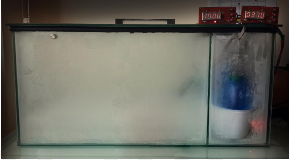
Resim 7. 37 °C de %100 nemli ortam oluşturan düzenek
