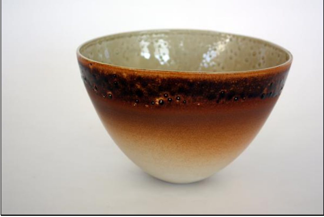
Resim 52: Gökçeören K Pomzası ile Sırlanmış Seramik Form, Döküm Yöntemi, 1200°C, (18x11,5x4) Erdal Tusun-2011
