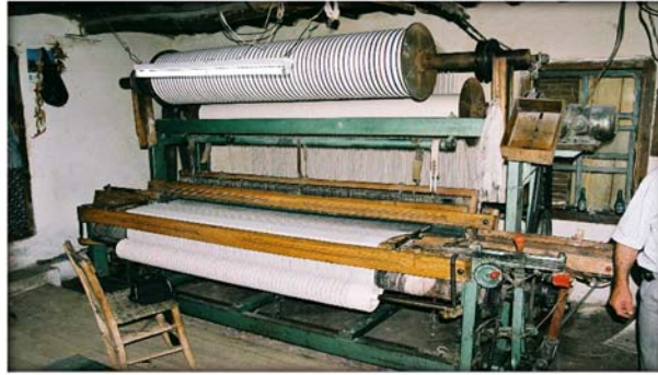
Şekil 24: Babadağ' da bir evde tezgâhtaki çözgü levendi (Korkmaz, 2015).
