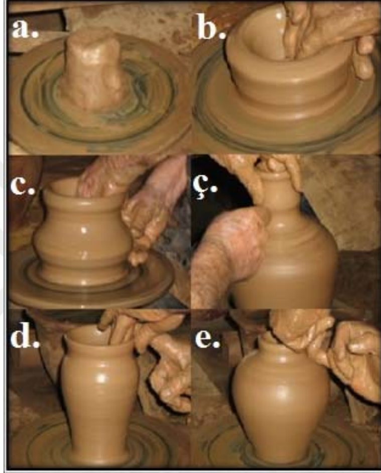
Şekil 52: A, b, c, ç, d, e. Hızla dönen çark üzerindeki kile ellerin kullanımı ile şekil verilmesi (Korkmaz,2016).
