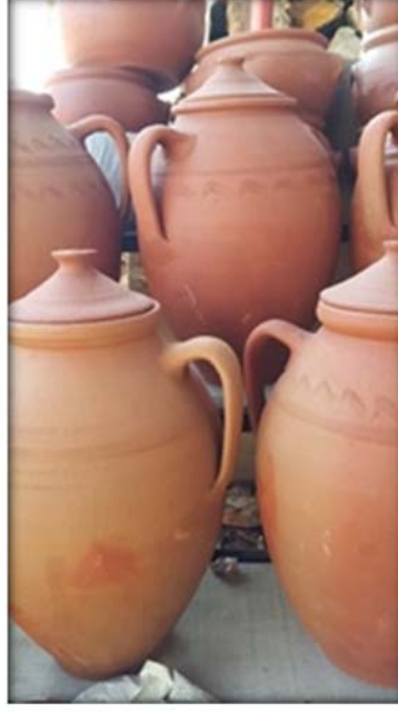
Şekil 55: Fırında pişirilmek üzere kurumaya bırakılan ürünler (Korkmaz, 2016).
