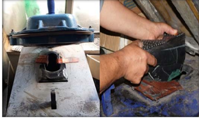
Şekil 88: Köselenin taban yapıştırma makinasında yapıştırılması (Korkmaz, 2016).
