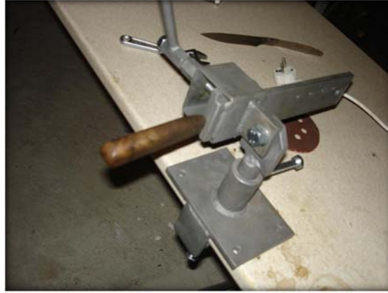
Şekil 65: Saplarına şekil vermek için mengeneye sıkıştırılan bıçak (Korkmaz,2016).
