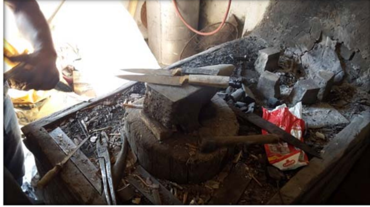
Şekil 64: Sapların ocakta ısıtılması (Korkmaz,2016).
