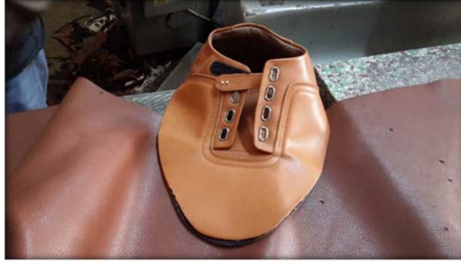
Şekil 85: Saya ile derinin birbirine yapışması (Korkmaz, 2016).
