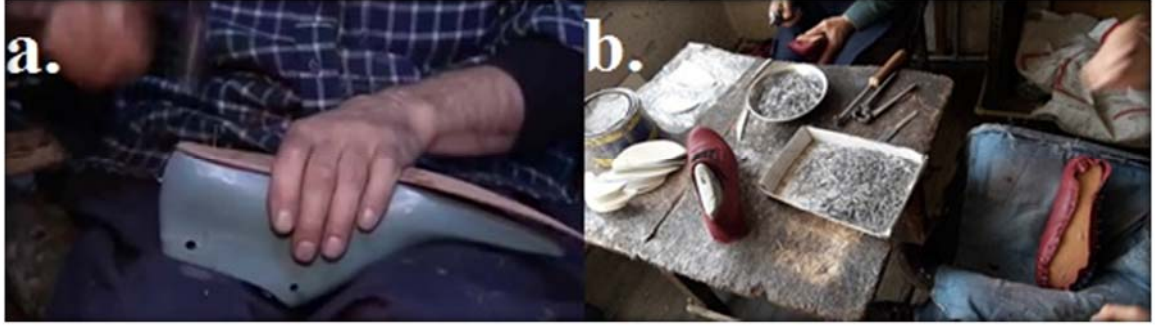
Şekil 86: a. Ayak şeklindeki sert kalıp, b. İç tabanı yerleştirmek için çivi ile sabitlemek (Korkmaz, 2016).
