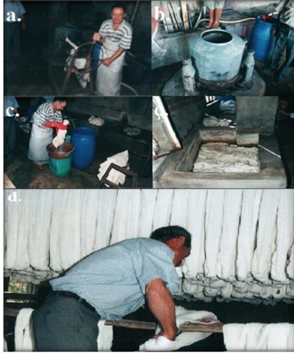
Şekil 27: a. Tokaçlanan çilelerin mengenede sıkılma işlemi, b. Otomatik mengene, c. Klorlama işlemi, ç. Gasser suyunda (Klor) bekletilen çileler, d. Havadar bir mekânda çilelerin düzeltilmesi ve bir gün boyunca kurutulması (Korkmaz, 2015).
