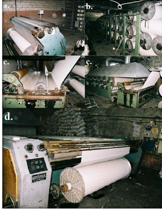
Şekil 28: a. Babadağ' da bir fabrikada bobinlerden çözgü levendlerine iplik sarma işlemi, b. Haşıl makinesine ilerleyen çözgü iplikleri, c.'Çözgü iplikleri haşıl makinasında, ç. Bulunan haşıl ve haşıl kurutma makinası, d. Haşılanmış, kurumuş hazır çözgü levendi (Korkmaz, 2015).
