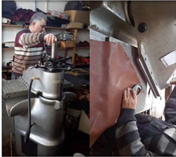
Şekil 83: Saya kesim makinasında derinin kesilmesi (Korkmaz, 2016).
