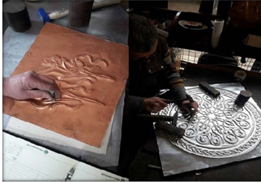
Şekil 71: Desenin bakır levha üzerine aktarılması, kalem ve çekiç yardımıyla şekil verme (Korkmaz,2016).
