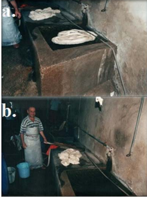
Şekil 26: a. Babadağ' da bir boyahanedede havuzda bekletilen iplikler; b. Islanan çilelere tokaçlama işlemi (Korkmaz, 2015).
