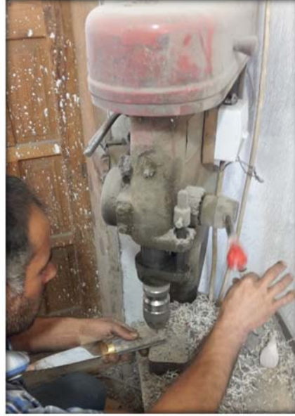
Şekil 62: Saplara delik açmak için kullanılan büyük matkap (Korkmaz,2016).
