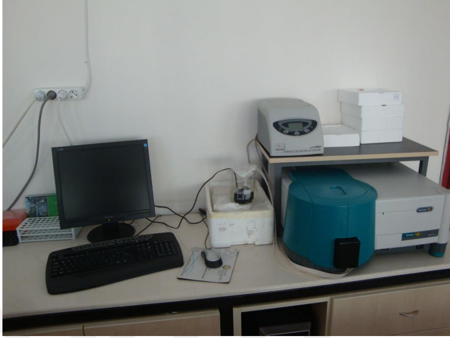
Resim 5. Kalsiyum sinyali analizlerinin yapıldığı spektrofloreometre cihazı
