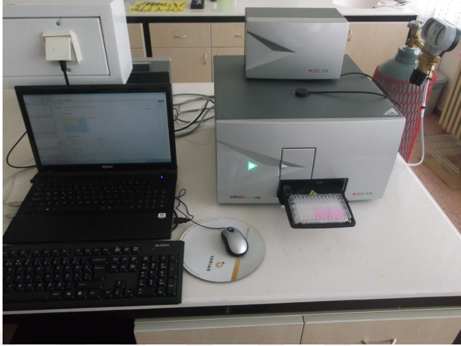
Resim 6. Floresans ve spektrofotometrik analizlerin yapıldığı kuyucuk okuyucu (plate reader) cihazı
