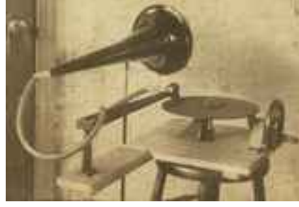
Şekil 1. 6: E. Berliner tarafından geliştirilen gramfon. (The early gramophone2016).
