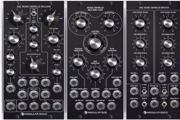
Şekil 2. 18: Voltaj Kontrollü Osilatör – Filtre – Amplifikatör modülü. (The Modules, 2016).
