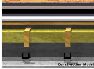
Şekil 2.105: U-Bot izolasyon sistemi. ( U-Boat™ Floor Floaters, 2017).
