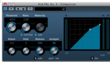
Şekil 2. 69: Yazılım (plug-in) kompresör ve kontrolör.
