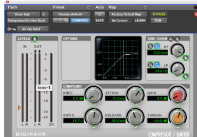
Şekil 2. 72: Kompresör/sınırlayıcı (compressor/limiter) yazılım (WHAT IS “KNEE” ON A COMPRESSOR?,2016).
