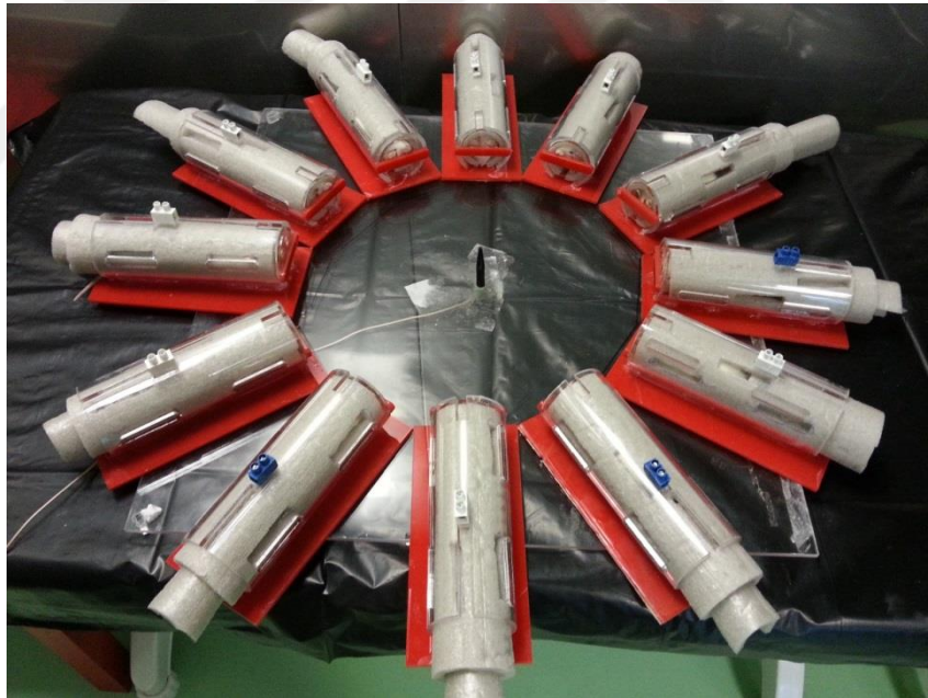
Resim 1. Carousel setup düzeneğine göre 12'li maruziyet tasarımı.
