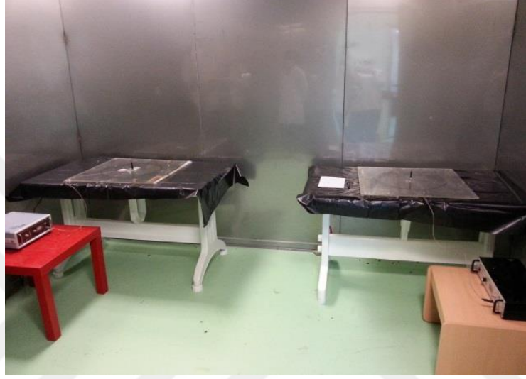
Resim 2. 217 Hz darbeleri ve ayarlı çıkış verebilen teset vericisi RF kaynağına bağlı monopul antenler ve EMA yalıtımlı oda
