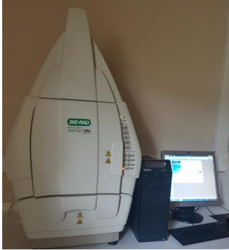
Şekil 3.5. Jel Görüntüleme Sistemi cihazıyla görüntü alınması
