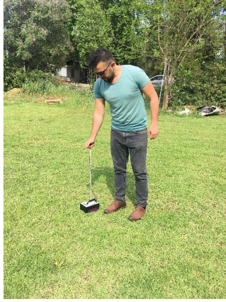
Şekil 4.7. TCM 500 NDVI ölçüm cihazı ile okuma yapılması
