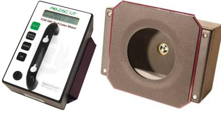
Şekil 3.6. TCM 500 NDVI turf color meter
