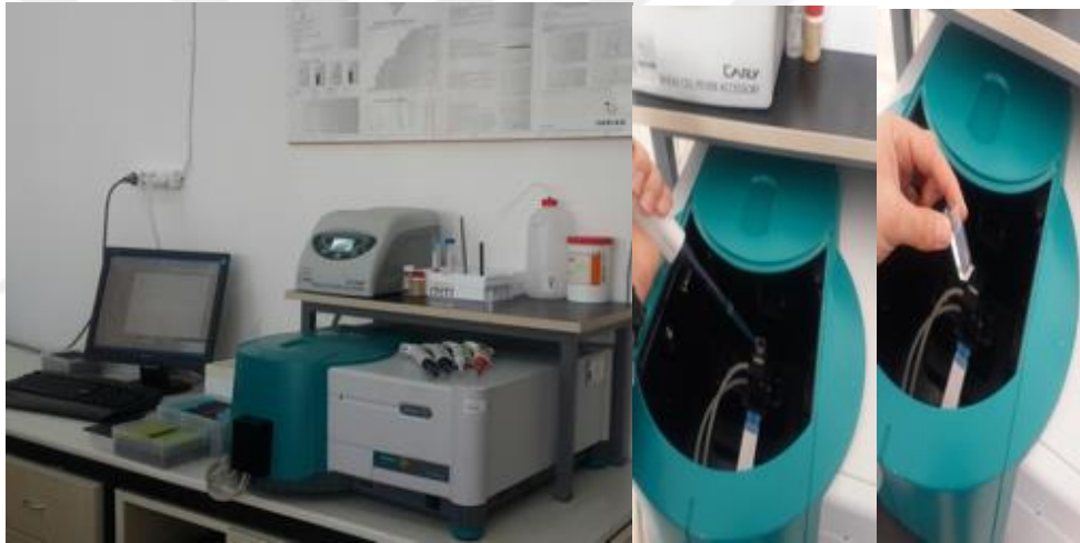
Resim 3. Hayvanlardan elde edilen Primer hipokampus sinir hcrelerinde ve in-vitro hcre hattında kalsiyum sinyali analizleri iin kullanılan floresans spektrofotometre cihazı (Cary Eclipse, Varian Inc, Sydney, Avustralya).
