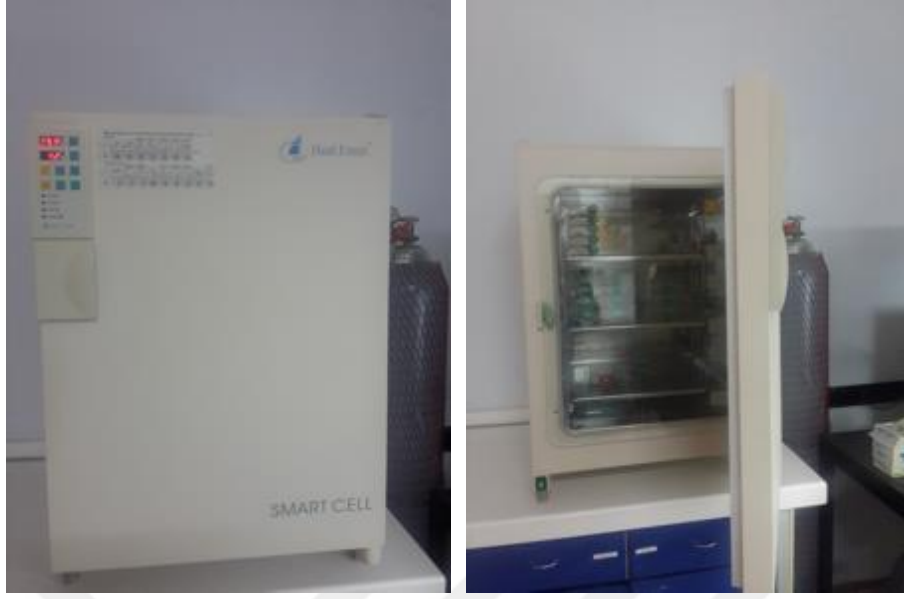
Resim 5. Hipokampal hücrelerin konulduğu vücut koşullarında koyduğumuz (37 °C, %5 CO 2 ) sıvı ceketli steril inkübatör.
