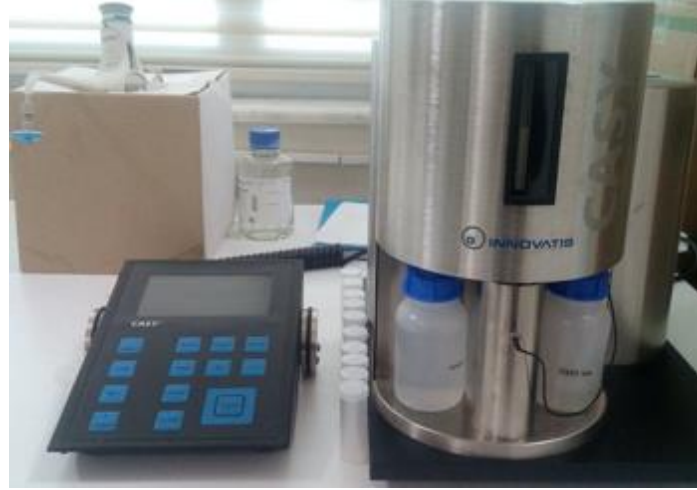
Resim 2. BSN Saęlık Analiz (Isparta, Gller Blgesi Teknokent) Laboratuvarında mevcut olup kullanılan Casy TT system hcre sayım cihazı (Almanya)
