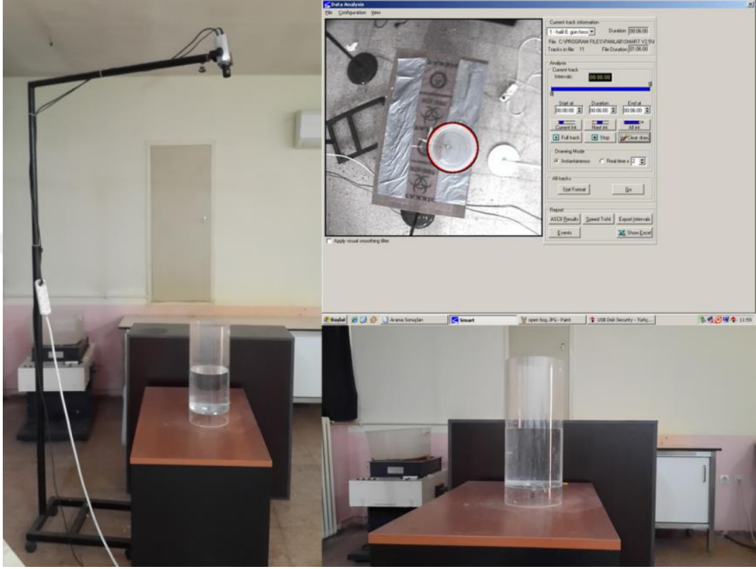
Resim 5. Zorlanmış Yüzme Testi Sistemi ve Tepe Kamerasından Görünüşü
