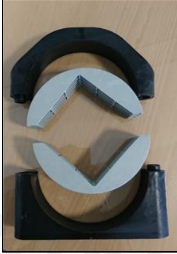
Şekil 3.5: Kullanılan yataklama sistemi-demonte hali-
