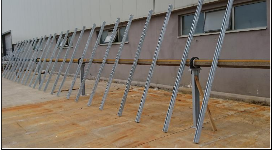
Şekil 3.2: Tek eksen güneş takip sistemi profil görüntüsü.
