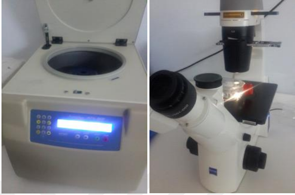
Resim 6. Herbir hücre türü için spesifik belirli devir hızı ve süresi döndürerek çöktürme işlemini yaptığımız santrifüj cihazı ve hücrelerin morfolojik şekillerini ve büyüme durumlarını değerlendirdiğimiz İverted mikroskop cihazı.
