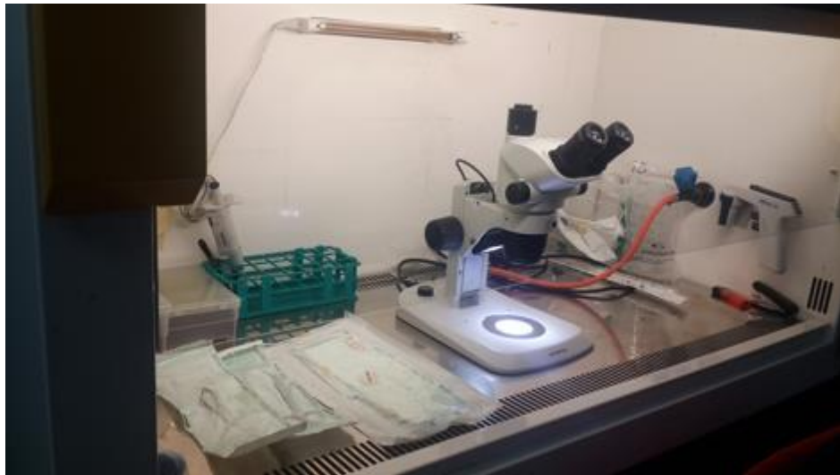
Resim 9. Hücre Kültüründeki Laminer flow cihazı. Hücrelerin flasklara ekimi, pasajlanma işlemleri, hücre kaldıma (tripsin yardımıyla) vs hücresel tüm işlemlerin yapıldığı steril ortam
