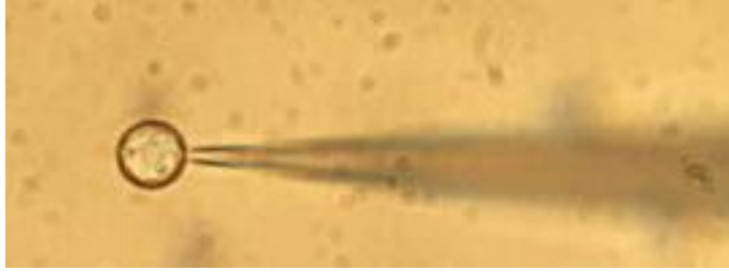
Resim 13. Hayvanlardan elde ettiğimiz primer duyusal nöron hücrelerinden tek bir AKG hücreinde patch-clamp kaydı alınırken, pipet tek bir hücreye temas ettiği esnada çekilmiş bir fotoğraf.
