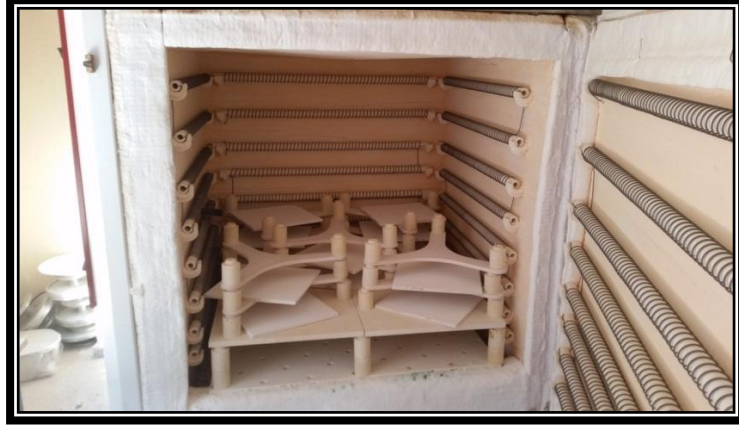
Şekil Ek 10. : Sırlanmış Alışmaların Fırına Doldurulması (Kaya, B.2017).
