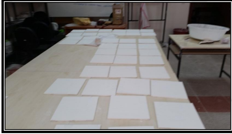
Şekil Ek 5. : Sırlanmış Çalışmaların Rötuş (Temizlenmek) Kurutulmaya Bırakılması (Kaya, B.2017)
