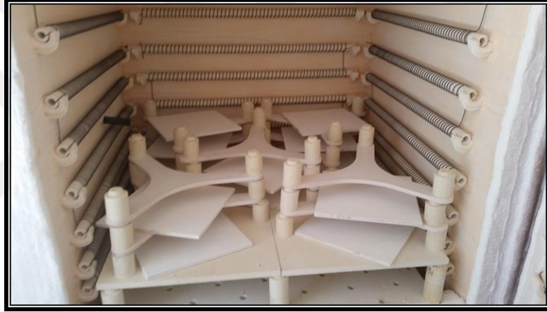
Şekil Ek 11. : Sırlanmış Alışmaların Fırına Doldurulması (Kaya, B.2017).
