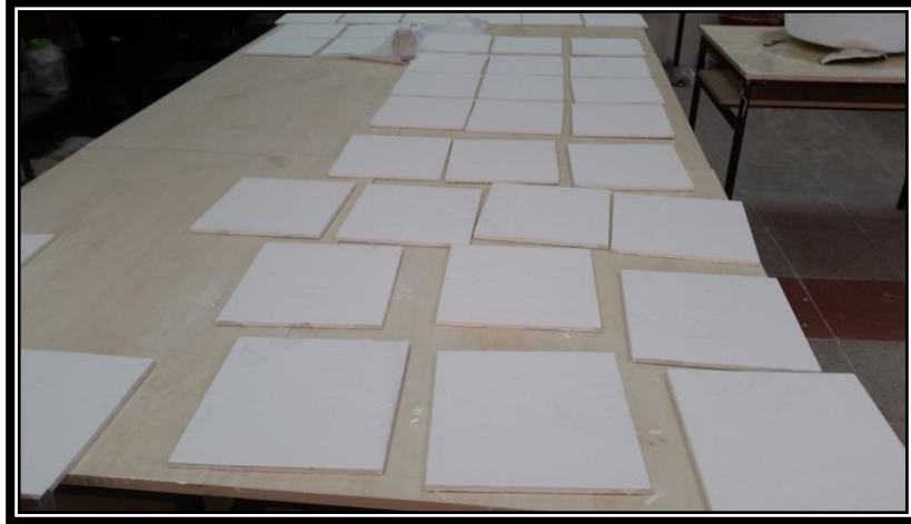
Şekil Ek 6. : Sırlanmış Çalışmaların Rötuş (Temizlenmek) Kurutulmaya Bırakılmasında Görünüm (Kaya, B.2017)
