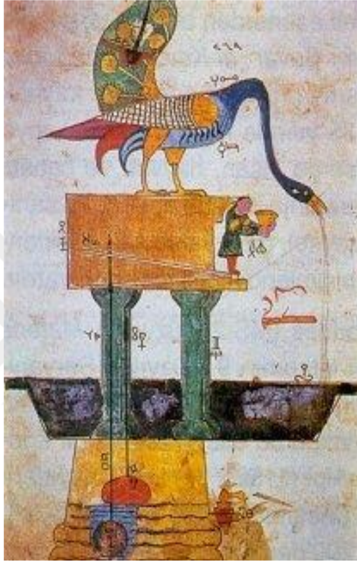
Şekil 5. El-Cezeri’nin Kitab fi Marifet el-Hiyal el-Hendesiye (Otomata) Tavus Kuşu Ağızından İçki Akıtan Otomatik Musluk (1206, Diyarbakır) (İstanbul Topkapı Müzesi Kitaplığı Hazine A.3472,H.414,Ahmed III:136a)
