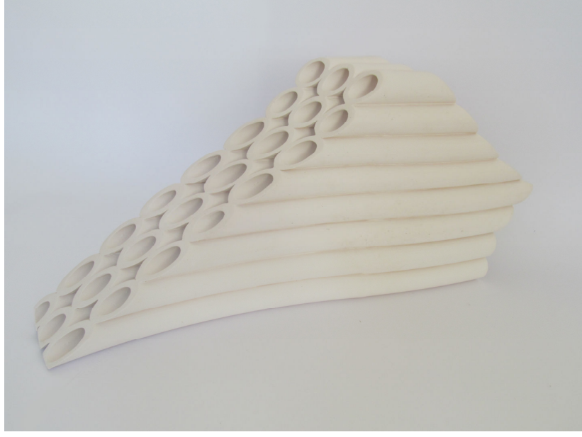
Resim 81. Döküm Yöntemi ile Şekillendirme, 9x45x24 cm, 1000°C
