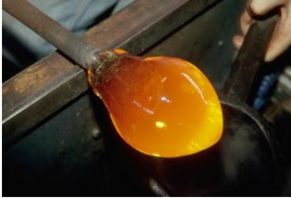
Şekil 48. : Kum, Kireç Taşı ve Soda Karışımının 1560 Dereceye Kadar Isıtılarak Akışkan Hale Getirilmiş Madde
