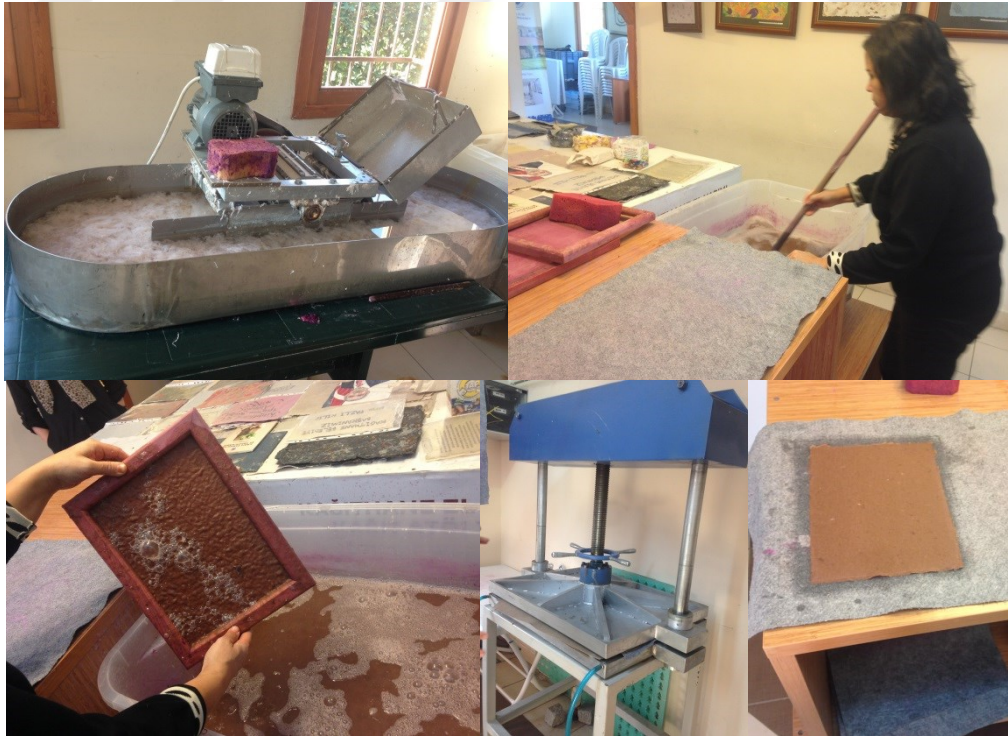
Şekil 1. : El Yapımı Kâğıt Üretim Aşamaları (Özer Soyduç, 2018)
