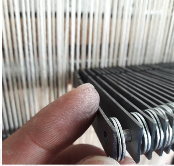
Şekil 21. Tarak Dişlerine Metal Çubuk Demirin Takılması
