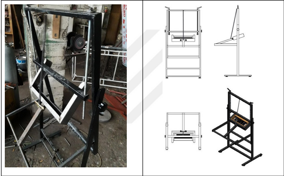
Şekil 13. a-b: Halı tezgâhının arkasına eklenen mekanizma ve tezgah üzerindeki konumu
