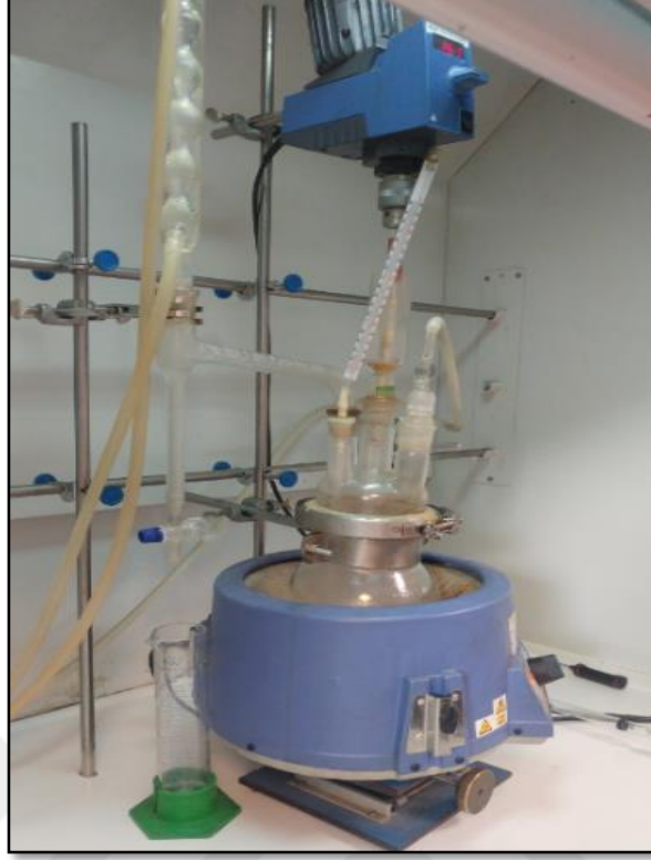
Şekil 3.1: Alkid Sentez Düzenegi, 4 Boyunlu Cam Reaktör Sistemi.
