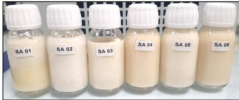
Şekil 4.22: Su Bazlı Alkid Numuneleri Depolama Öncesi.
