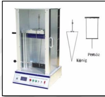
Şekil 3.8: Sertlik Derecesi Ölçüm Sistemi (König Sarkacı).
