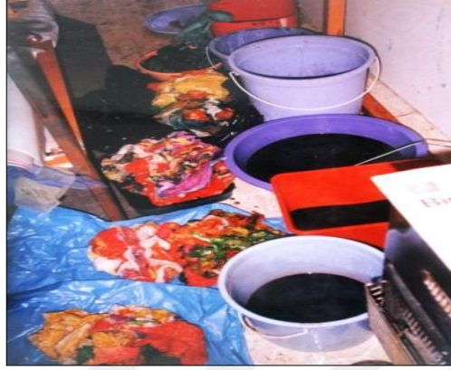
Şekil 64. : Batik Tekniğinde Her Renk İçin Hazırlanmış Boyalar ve Boyanmayı Bekleyen Mumlanmış Kupon Kumaşlar
