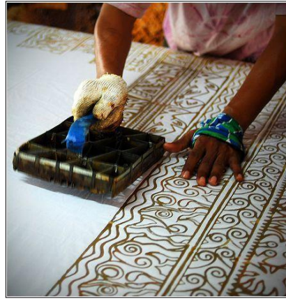
Şekil 38. : Tjamp ile Metraj Batik Baskısı Yapılırken ( https://tr.pinterest.com/pin/531706299730738177/ (10 Mayıs 2019))
