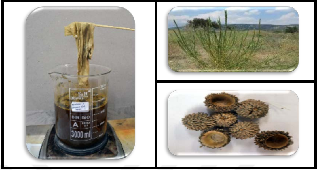
Şekil 3.12. Muhabbet Çiçeği Bitkisinden Elde Edilen Boyar Maddenin Palamutözü Mordan Tekniği ile Pamuklu Kumaşlar Üzerine Uygulama Aşaması (sol), Kullanılan Bitki (sağ üst) ve Mordan Materyali (sağ alt).
