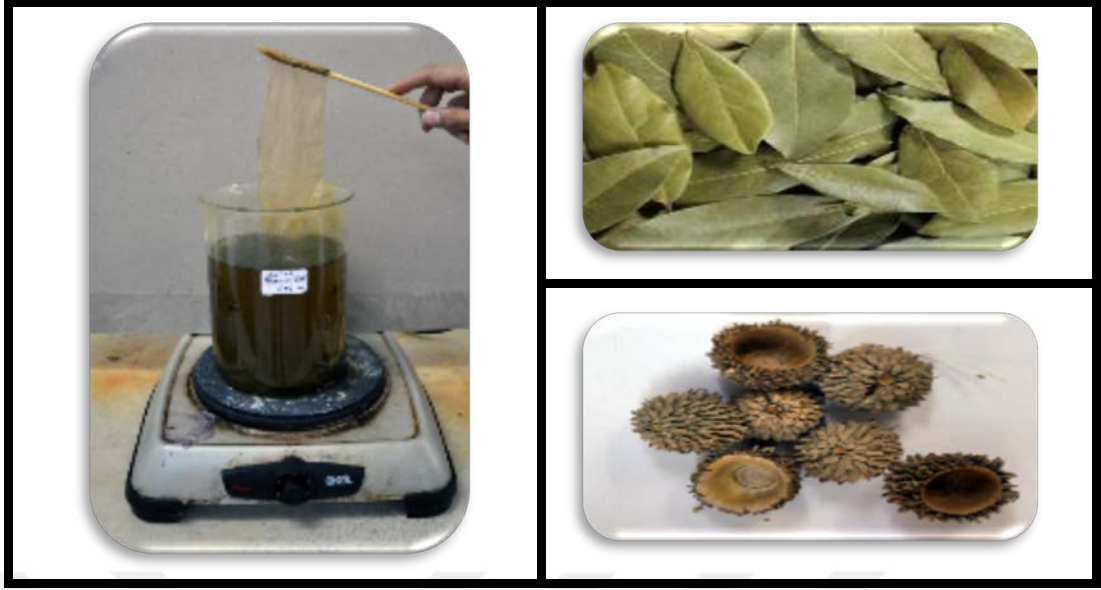
Şekil 3.22. Akdeniz Defnesi Bitkisinden Elde Edilen Boyar Maddenin Palamutözü Mordan Tekniği ile İpekli Kumaşlar Üzerine Uygulama Aşaması (sol), Kullanılan Bitki (sağ üst) ve Mordan Materyali (sağ alt).
