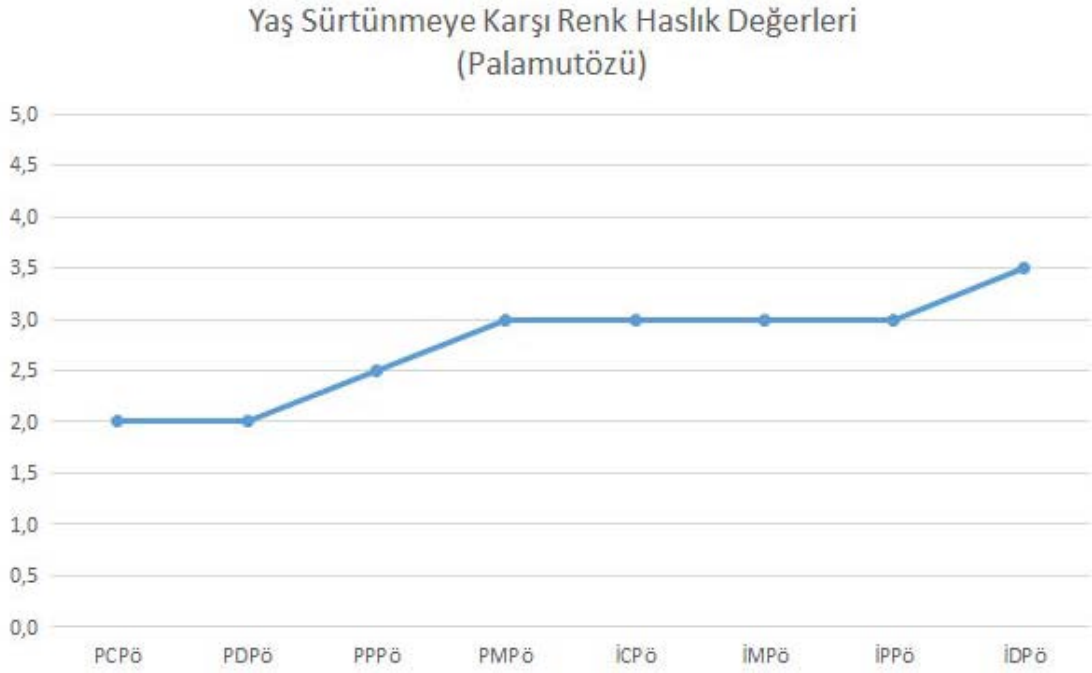
Şekil 4.22. Cehri, Muhabbet Çiçeği, Papatya ve Defne Boyar Maddelerinin Palamutözü Mordanlama Tekniği ile İpek ve Pamuk Kumaşlara Uygulanması Sonucu Elde Edilen Yaş Sürtünmeye Karşı Renk Haslık Değerleri
