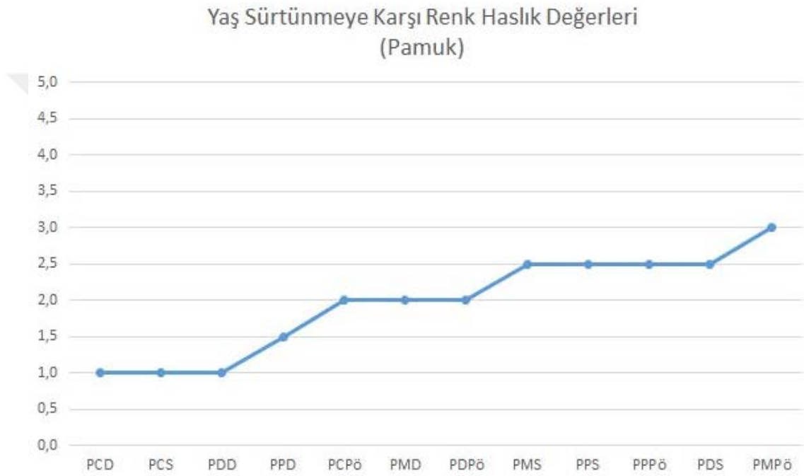
Şekil 4.25. Cehri, Muhabbet Çiçeği, Papatya ve Defne Boyar Maddelerinin Farklı Mordanlama Tekniği ile Pamuk Kumaşlara Uygulanması Sonucu Elde Edilen Yaş Sürtünmeye Karşı Renk Haslık Değerleri
