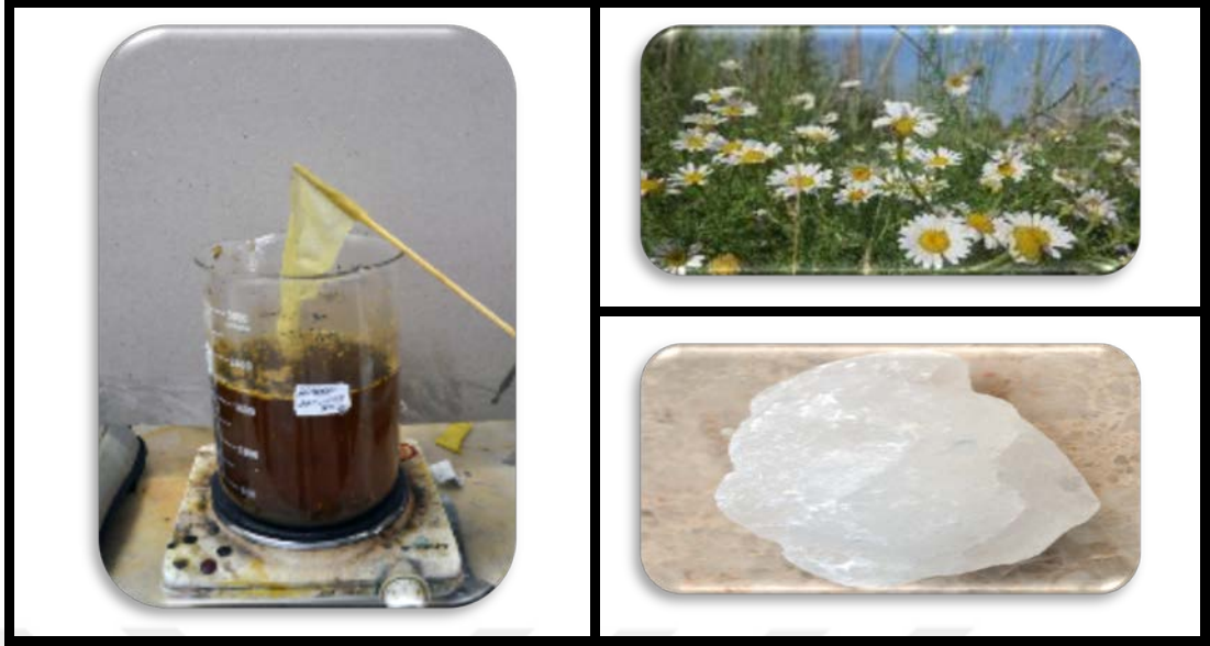
Şekil 3.21. Papatya Bitkisinden Elde Edilen Boyar Maddenin Şap Mordan Tekniği ile İpekli Kumaşlar Üzerine Uygulama Aşaması (sol), Kullanılan Bitki (sağ üst) ve Mordan Materyali (sağ alt).
