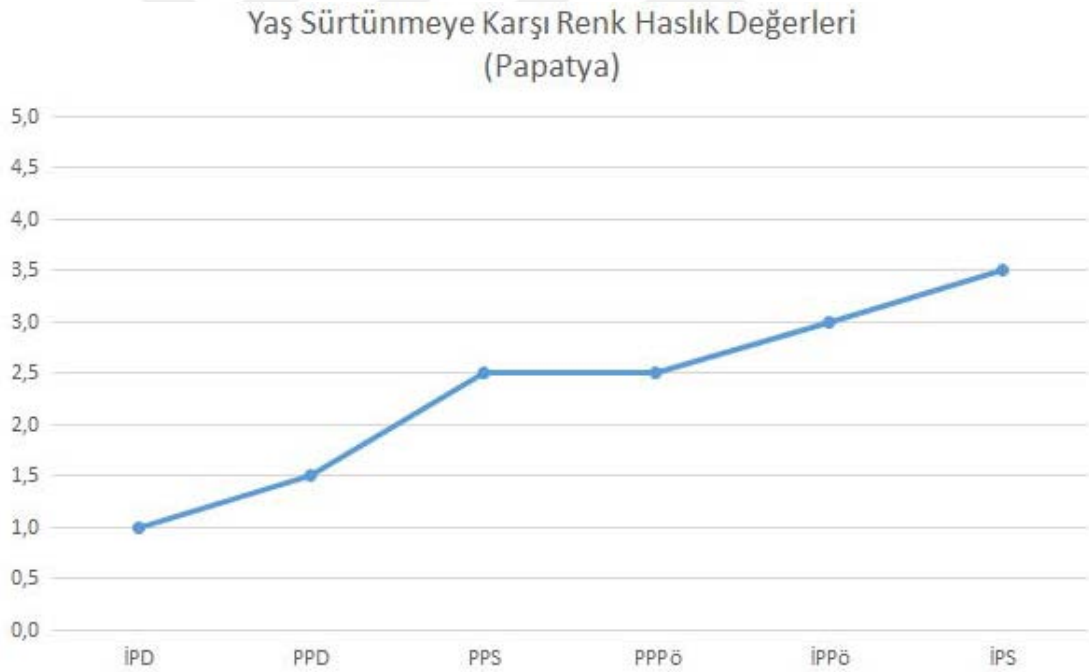
Şekil 4.3. Papatya Boyar Maddesinin Farklı Mordanlama Teknikleri ile İpek ve Pamuk Kumaşlara Uygulanması Sonucu Elde Edilen Yaş Sürtünmeye Karşı Renk Haslık Değerleri
