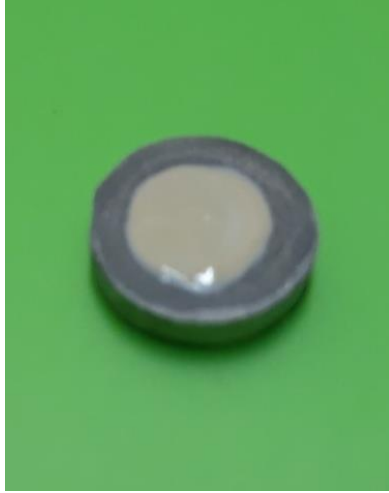
Resim 17. 0,1 mm kalınlığında metal primer-preopak-opak uygulanmış metal alt yapı
