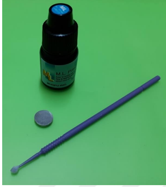
Resim 13. Metal-indirekt kompozit bağlantısı için kullanılan metal primer
