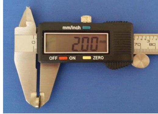
Resim 7. Döküm yoluyla elde edilen 10x2 mm ebatlarında Co-Cr diskler
