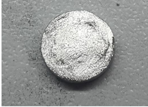
Resim 5. Tesviyesi yapılmış kobalt-krom (Co-Cr) disk örneği
