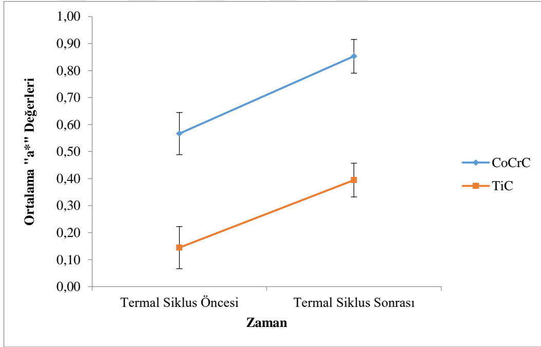
Grafik 12. Örneklerin termal siklus uygulaması farklı zaman aralıklarında (öncesi ve sonrası) ortalama a^* değerlerinin ve standart hatalarının grafiği
