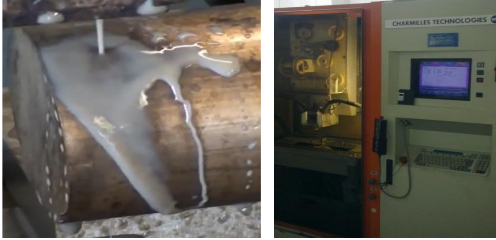
Resim 9. Tel erozyon yöntemi ile titanyum disklerin elde edilmesi
