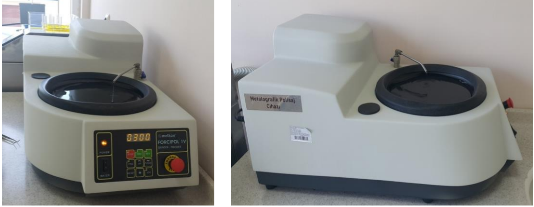
Resim 10. Metalografik polisaj cihazı
