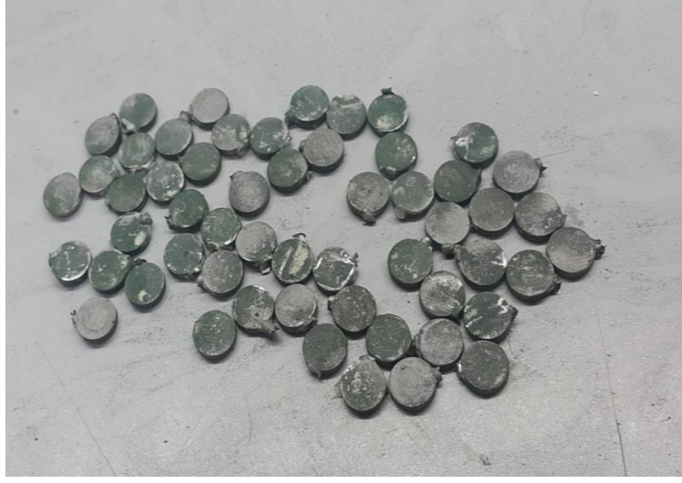
Resim 4. Döküm kanalları uzaklaştırılmış kobalt-krom (Co-Cr) diskler
