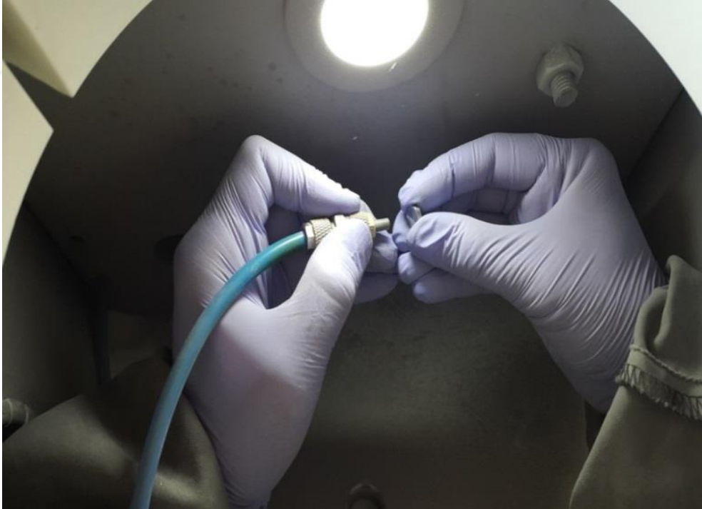
Resim 11. Kumlama cihazında 110 \mu\text{m} 'lik \text{Al}_2\text{O}_3 ile metal örneklerin kumlanması
