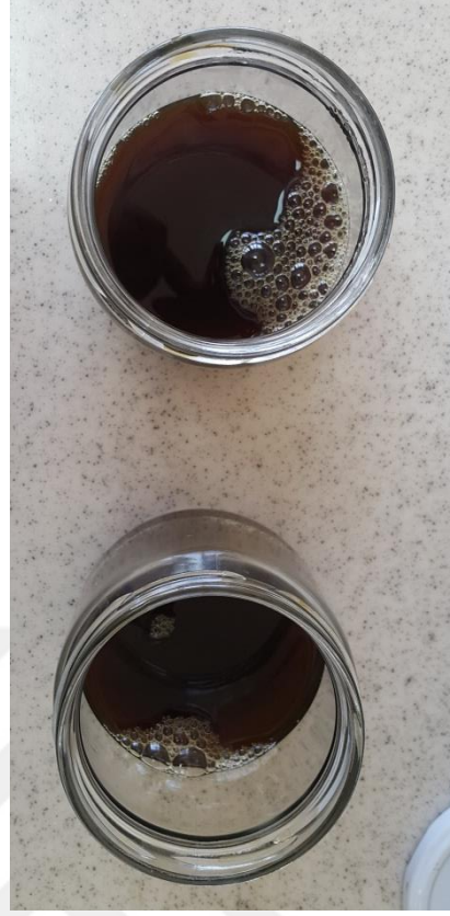
Resim 32. Kahve solüsyonu içerisinde yerleştirilmiş örnekler (CoCrC/TiC)
