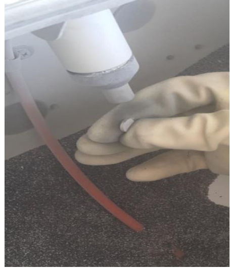
Resim 6. Kumlama cihazı ve 250 mikrometre ( \mu\text{m} ) partikül boyutunda \text{Al}_2\text{O}_3 ile kumlama yapılan kobalt-krom (Co-Cr) diskler
