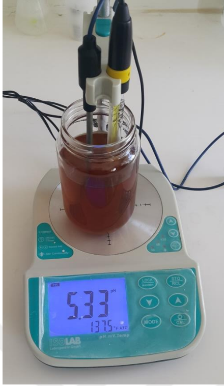
Resim 29. ay solüsyonu pH ölçümü
