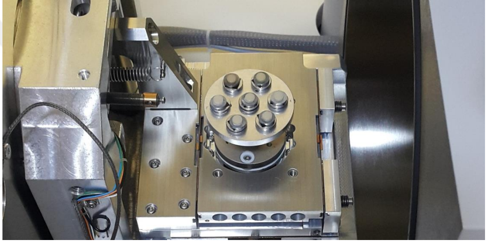
Resim 35. SEM analizi için örneklerin taramalı elektron mikroskobuna (FEI Quanta Feg 250, Hollanda) yerleştirilmesi
