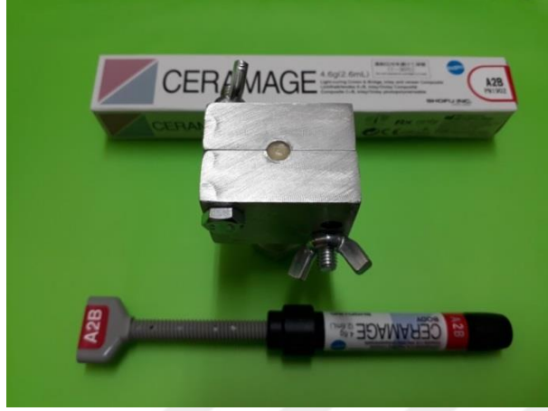
Resim 19. Metal jig içerisinde tabakalar şeklinde kondanse edilmiş Ceramage
