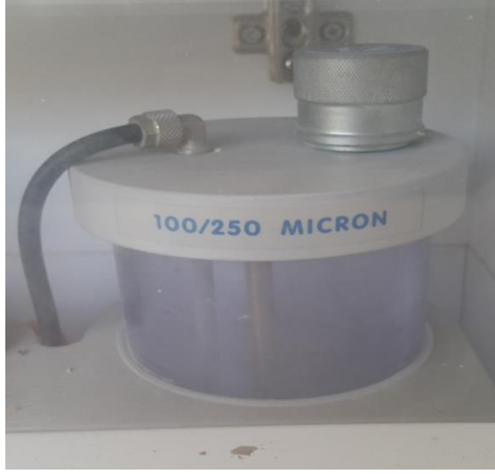
Resim 6. Kumlama cihazı ve 250 mikrometre ( \mu\text{m} ) partikül boyutunda \text{Al}_2\text{O}_3 ile kumlama yapılan kobalt-krom (Co-Cr) diskler
