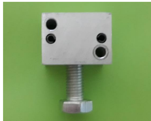
Resim 18. Ceramage'ın metal alt yapılar üzerine standart olarak yerleştirilmesi amacıyla tasarlanan metal jig
