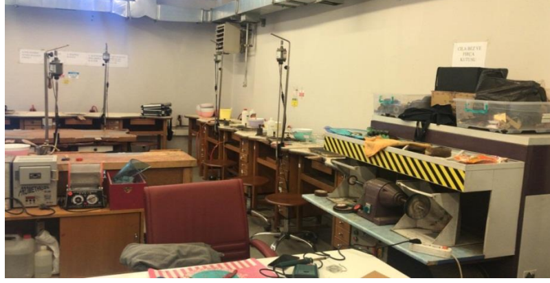
Şekil 2. Marmara Üniversitesi Takı Teknolojisi ve Tasarımı Yüksek Okulu Kuyumculuk Atölyesi, Cila Motoru, Freze Motoru (Delme), Tezgahlar (Balta, 2019)
