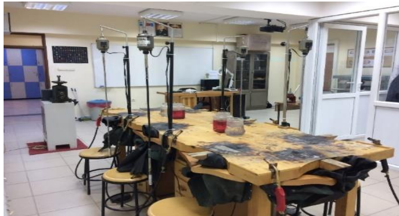
Şekil 4. Gazi Üniversitesi Sanat ve Tasarım Fakültesi Kuyumculuk ve Mücevher Tasarımı Lisans Programı Kuyumculuk Atölyesi, 8 Kişilik Tezgah, Freze Motoru, Silindir (Yarı Mamül Makinası) (Balta, 2019)
