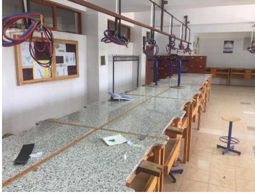
Şekil 8. Kütahya Dumlupınar Üniversitesi Teknik Bilimler Meslek Yüksek Okulu Kuyumculuk Atölyesi, 16 Kişilik Tezgah, Merkezi Oksijen Kaynak Sistemi, Cila Motoru (Balta, 2019)
