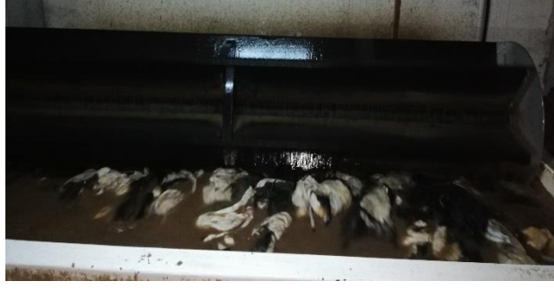
Şekil 107. Kelebek makinesinde ıslatma- yumuşatma işlemi (Halit Özdamar arşivi, Isparta- 2019).
