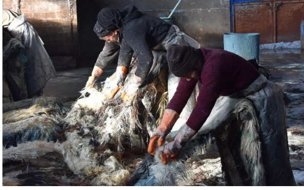
Şekil 109. Kılların sıyırılması (Halit Özdamar arşivi, Isparta- 2019).
