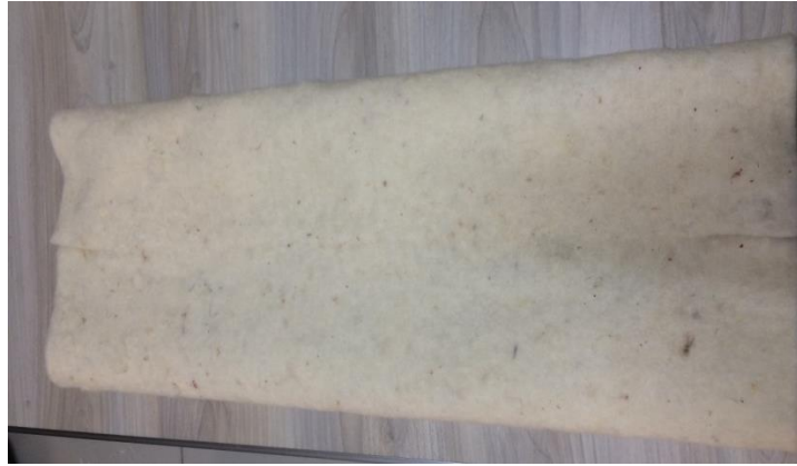
Görsel 58. Keçenin Ortadan Birleştirilmiş Hali(Arpaözü,2020)
