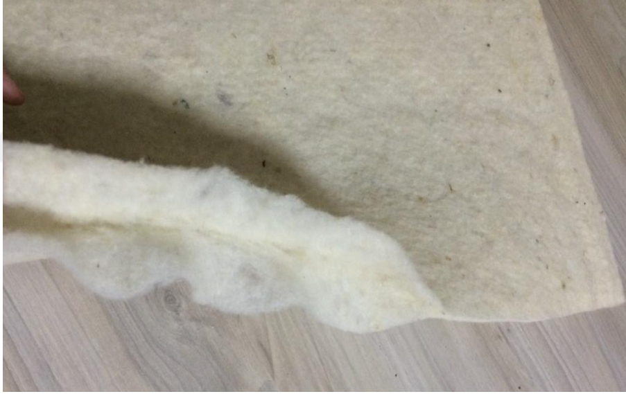
Görsel 56. Kenar Katlarının Ayrılmasına Örnek(Arpaözü,2020)
