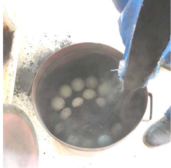
Fotoğraf 57: Deney Plakalarından Sonra Ara Katman Olarak Kömür Eklenmesi
