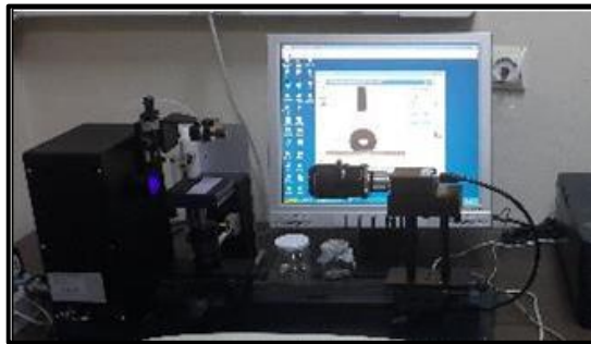
Şekil 5.7: KSV CAM 200 temas açısı ölçüm cihazı.
