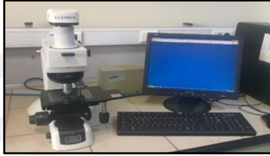
Şekil 5.6: NIKON Eclipse LV 150L optik mikroskop cihazı.
