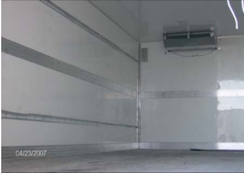
Foto 9: Özel Donanımlı Soğutma Sistemine Sahip Bir Nakliye Aracındaki Soğutma Sistemi
