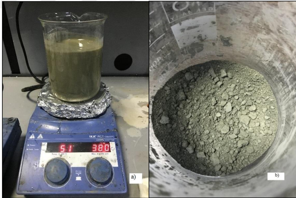
Şekil 4.1 : a) Kompozisyonda ki tozların karıştırılması b) Kurutulmuş NiO-YSZ anot destek tabakası tozu
