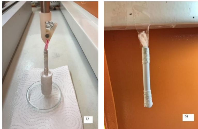
Şekil 4.8 : a) Daldırma yöntemiyle AFT kaplanmış hücrelerin kaplanması b) Askıda bırakılarak oda sıcaklığında kurutulması.
