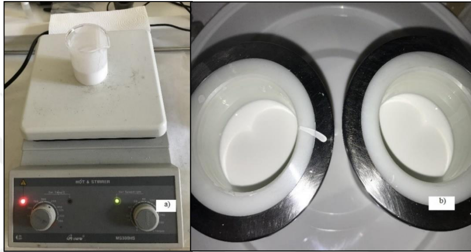
Şekil 4.7 : a) Elektrolit solisyonunda ki malzemelerin karıştırılması b) Karıştırılan solüsyon ince tane boyutu elde etmek için gezegensel değirmen kullanımı.
