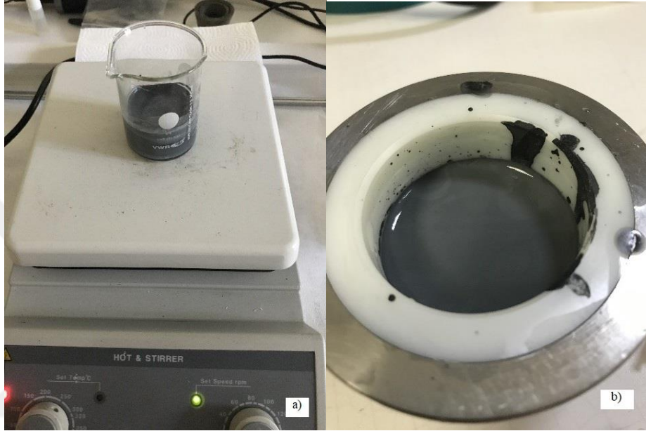
Şekil 4.10 : a) Katot solüsyonun kompozisyonundaki malzemelerin karıştırılması b) Karıştırılan solüsyon ince tane boyutu elde etmek için gezegensel değirmen kullanımı.
