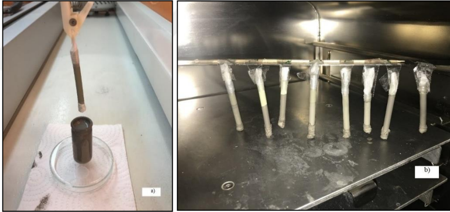
Şekil 4.5 : a) Daldırma yöntemiyle boru tipi hücreler kaplanması b) Askıda bırakılarak oda sıcaklığında kurutulması.
