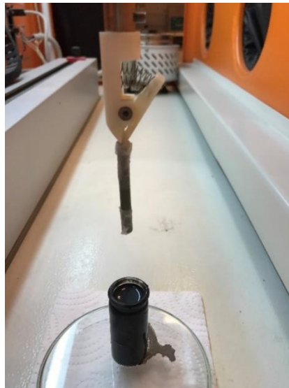
Şekil 4.11 : Daldırma yöntemiyle AFT ve Elektrolit kaplanmış hücrelerin katot kaplanması.
