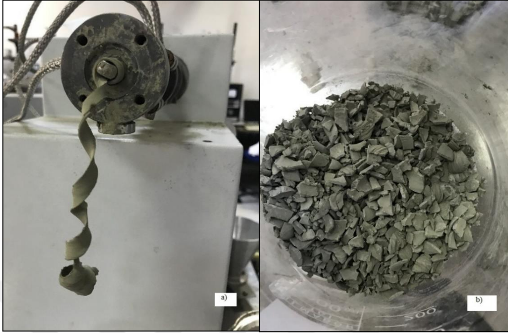
Şekil 4.2 : a) ve b) NiO-YSZ tozlarının granül hale getirilmesi.
