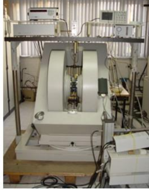
Şekil.3.8. ESR spektrometresi blok diyagramı (a) ve Bruker EMX spektrometresi (GTÜ) (b)
