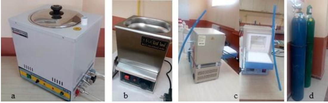
Fotoğraf 3.2. Ömer Halisdemir Üniversitesi Fizik Ana Bilim Dalı Nanobilim ve Nanoteknoloji laboratuvarında bulunan saf su elde etme cihazı (a), ultrasonik temizleyici (b), yüksek sıcaklık fırını (c) ve argon (Ar) ve azot (N 2 ) gazları (d) içeren tüpler
