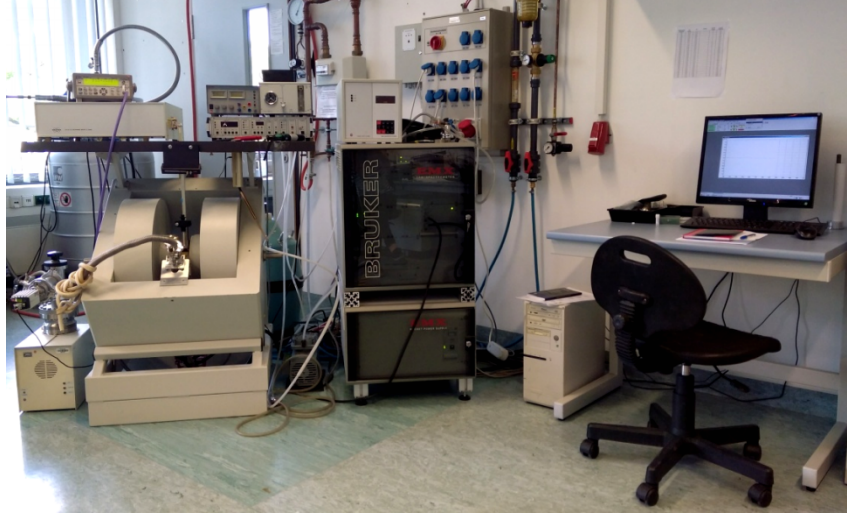
Fotoğraf 4.4. IFW-Dresden ESR laboratuvarında bulunan Bruker Model X-Band ESR spektrometresinin genel bir görünümü
