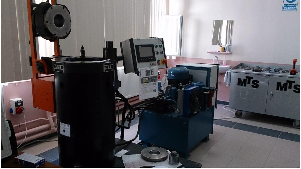
Fotoğraf 3.6. Şekillendirme sınır diyagramı deney düzeneği
