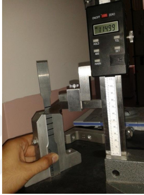
Fotoğraf 3.2. Anizotropi deney numunelerinin hazırlanması
