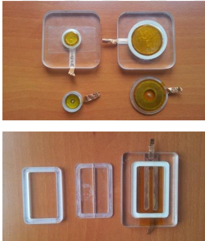
Fotoğraf 2.8. Dairesel ve düz elektrotlu plazma sentetik jet aktüatör modellerinin imalat sonrası görünümü
