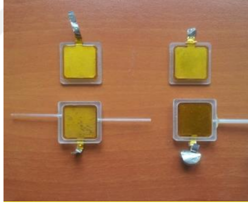
Fotoğraf 3.1. DBD yöntemi ile hacim plazmalı sentetik jet aktüatörü
