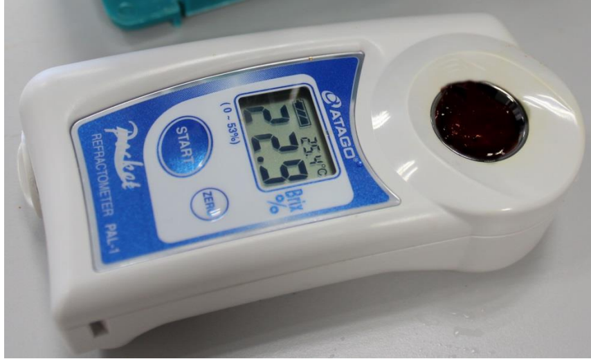
Fotoğraf 3.4. Refraktometre ile SÇKM ölçümü
