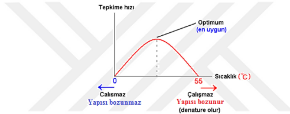
Şekil 2.11. Enzimin sıcaklığa göre reaksiyon hızının değişimi
