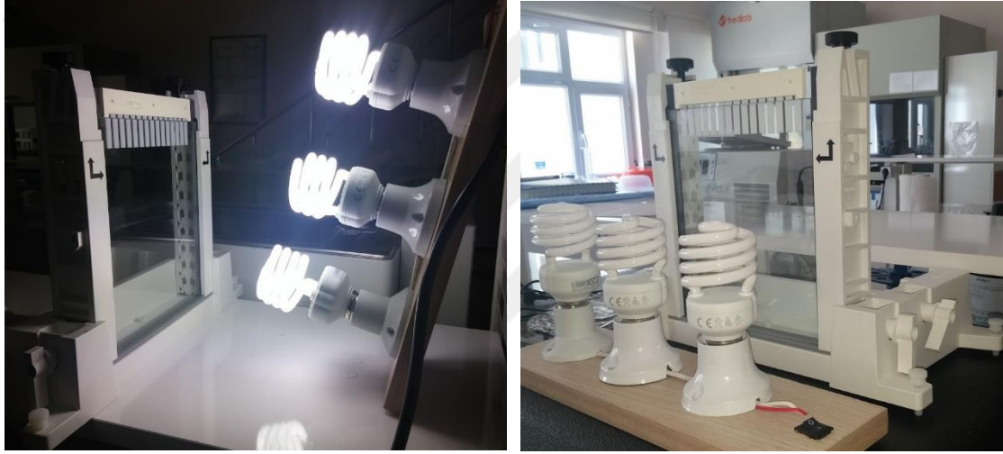
Fotoğraf 3.1. AAÜ-PAGE yönteminde jelleşmeyi başlatmak için kullanılan aydınlatma düzeneği
