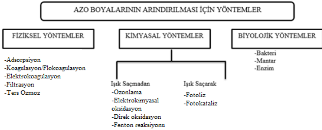
Şekil 2.2. Boyar maddelerin sulu ortamlardan uzaklaştırılması için kullanılan bazı yöntemler
