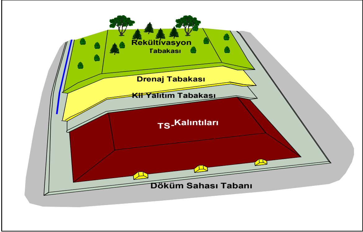
Şekil 4.17. TS kalıntıları için döküm sahasının prensip şeması
