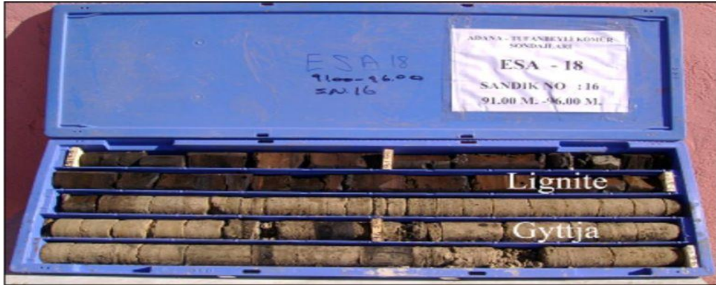
Fotoğraf 3.2. Araştırma sondajlarından alınan karotlar
