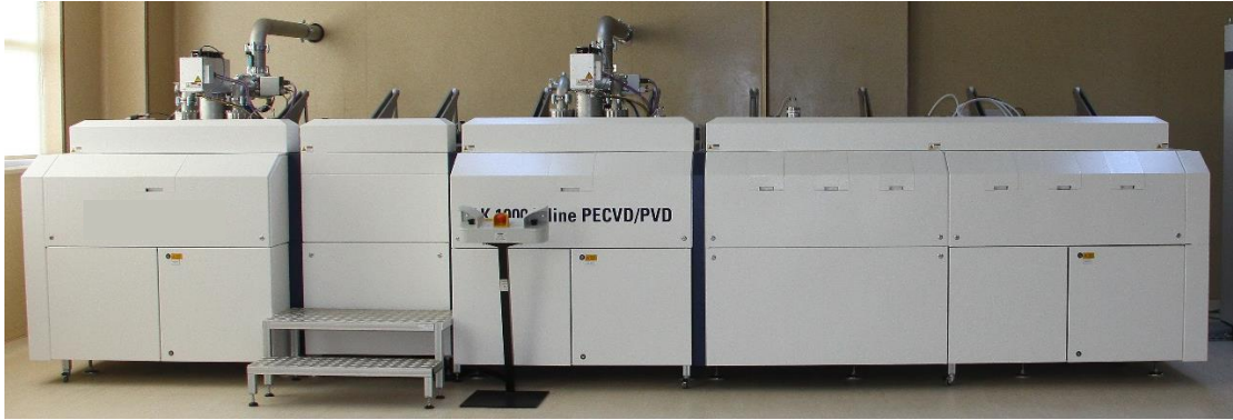
Fotoğraf 3.1. Niğde Ömer Halisdemir Üniversitesi Nanoteknoloji Araştırma ve Uygulama Merkezinde Kullanılan Meyer Burger marka PECVD/PVD sistemi
