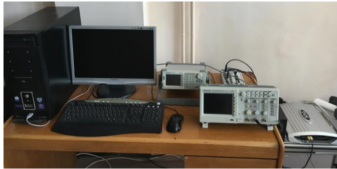
Fotoğraf 2.4. Deneylerde kullanılan sinyal jeneratörü, BNC DAQ ve Osiloskop
