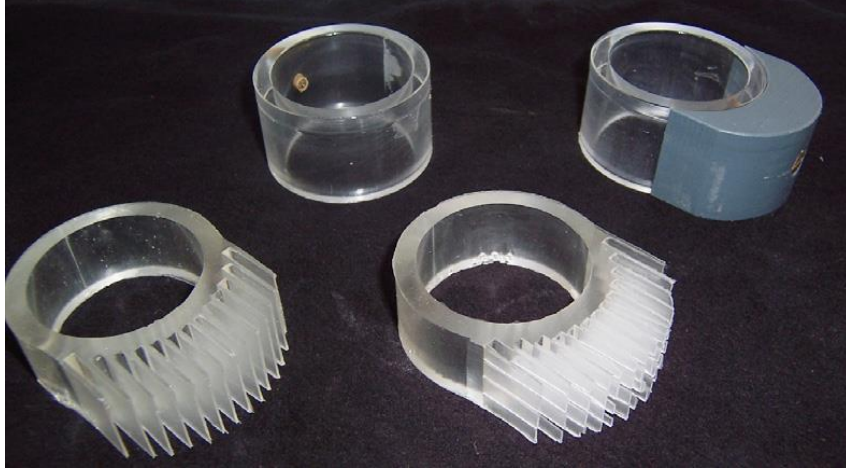
Şekil 1.1. Pasif akış görüntülemeye kullanılan farklı geometriler (Kunze ve Brücker, 2012)
