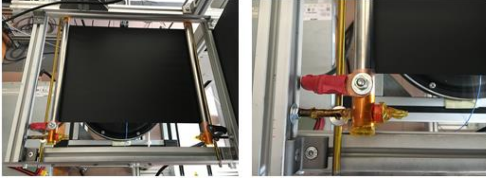
Fotoğraf 2.6. Paslanmaz çelik film levha montaj şekli
