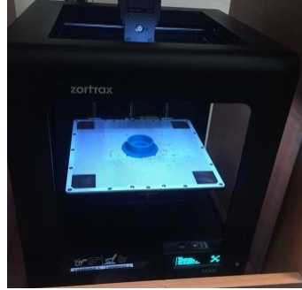
Fotoğraf 2.3. 20 mm çapa sahip lüle üretimi
