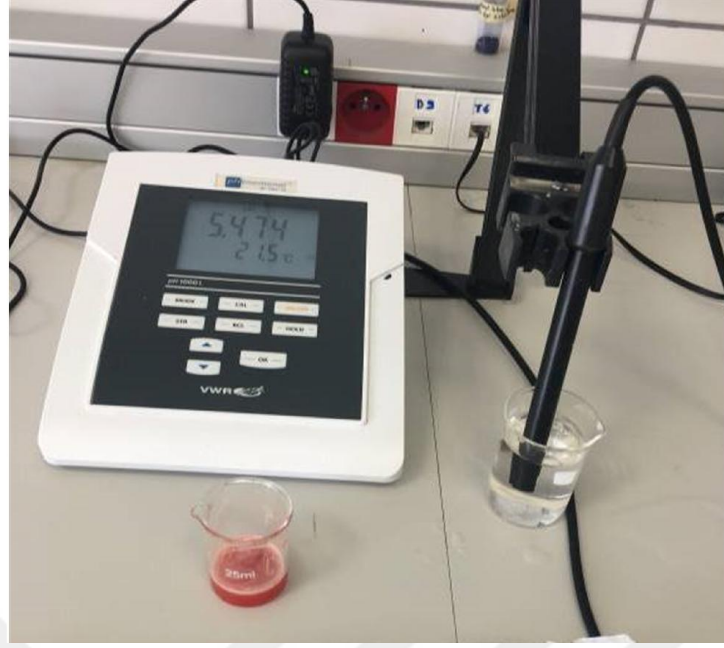
Şekil 3.5. Domates örneklerinin pH tayini ölçülmesi
