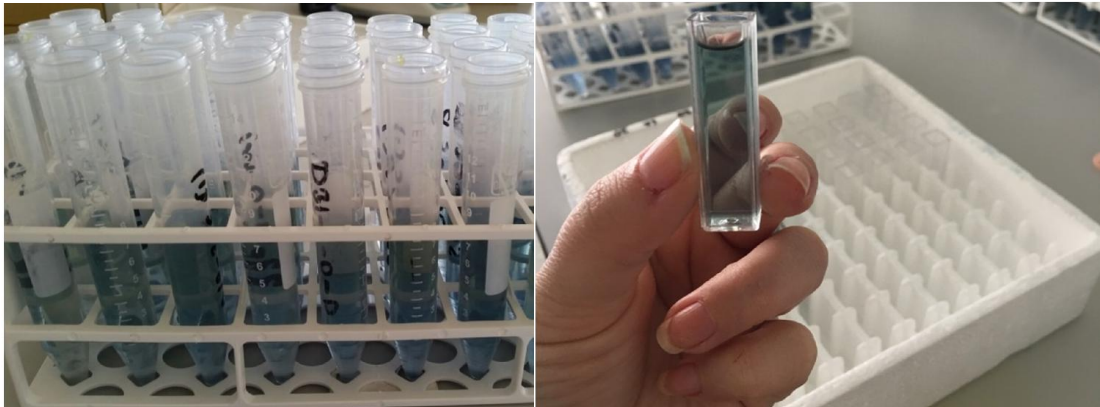
Şekil 3.6. Toplam fenolik analizinde Folin-Ciocalteu's ilavesinden sonra örneklerin inkübasyon aşaması
