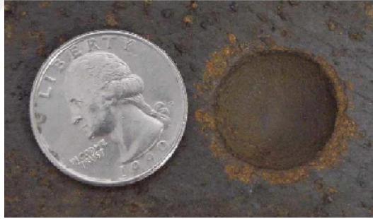
Fotoğraf 2.14. Yağlı su hattında meydana gelen büyük bir çukur görüntüsü
