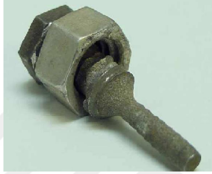
Fotoğraf 2.10. Bir civatanın galvanik korozyonu
