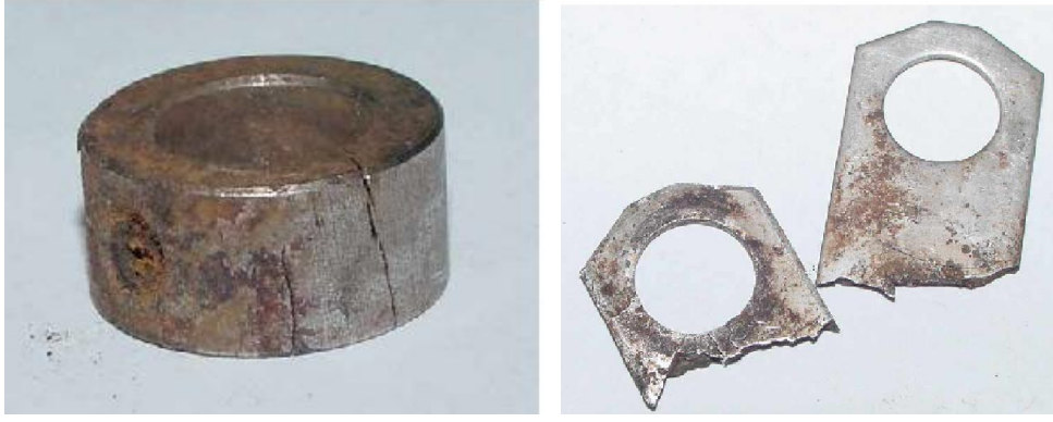
Fotoğraf 2.19. Klorür kaynaklı stres korozyon çatlama görüntüsü
