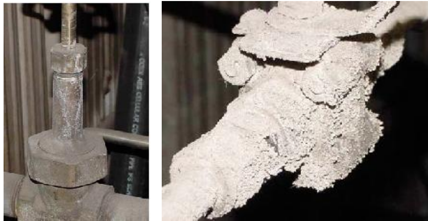
Fotoğraf 2.30. Bir pirinç vana seçici korozyonu
