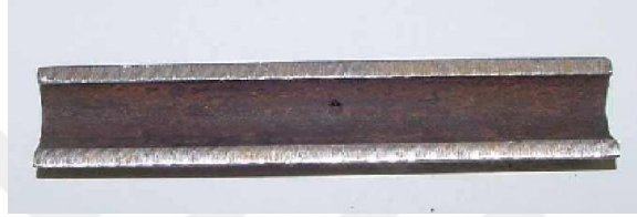
Fotoğraf 2.17. 1-in aplı elik su borusunda oluřan solucan deliđi ukur grnm
