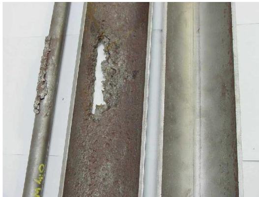
Fotoğraf 2.15. Yağlı bir su hattındaki çukurlaşma görüntüsü
