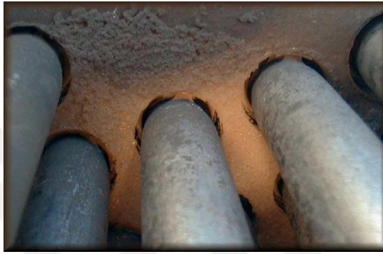
Fotoğraf 2.29. Aralık korozyonunun tüp ve kabuk ısı değiştiricilerdeki yaygın görünümü
