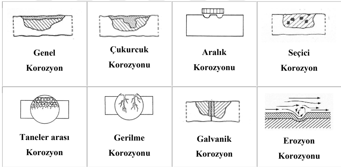
Şekil 2.3. Korozyon çeşitlerinin şematik gösterimi
