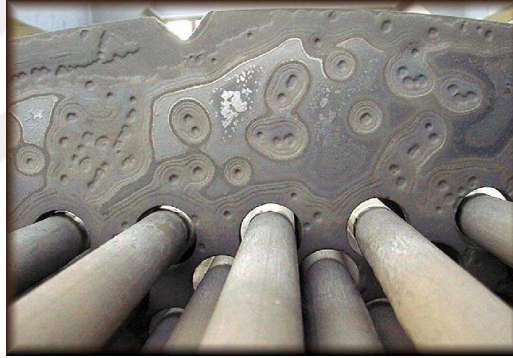
Fotoğraf 2.23. Tüp ve ısı değiştirici kabukta sıvı hızı etkisinin görünümü
