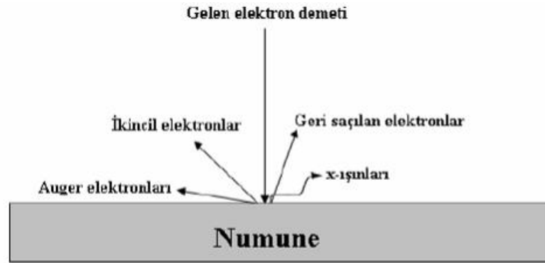
Şekil 2.23. SEM'de gelen elektron demeti ile numunenin etkileşimi
