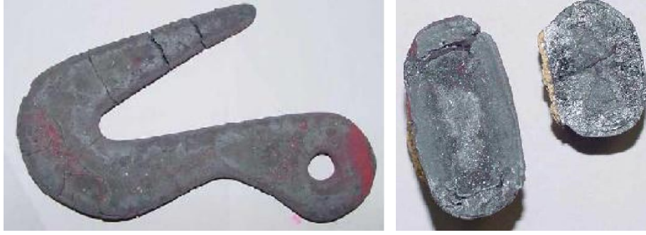
Fotoğraf 2.22. Taneler arası korozyona örnek özel bir durum, yüksek sıcaklıklarda karbonlamaya uğrayan çelik kanca görüntüsü
