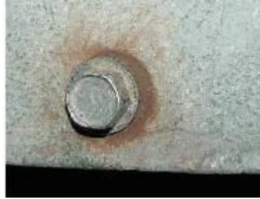
Fotoğraf 2.11. Bir pompa gövdesi üzerindeki civatanın galvanik korozyonu
