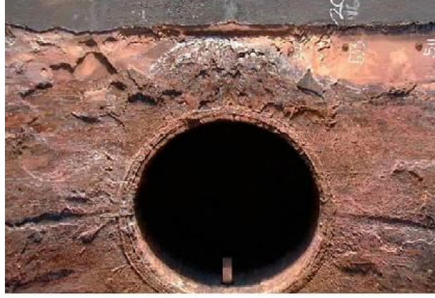
Fotoğraf 2.25. Bir tüp ve kabuk ısı deęiřtiricinin bir meme çevresinde řiddetli erozyon korozyonu
