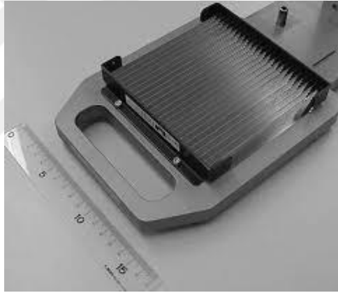
Resim 3.15. Pasif saçılma tekniğinde kullanılan eđer filtre
