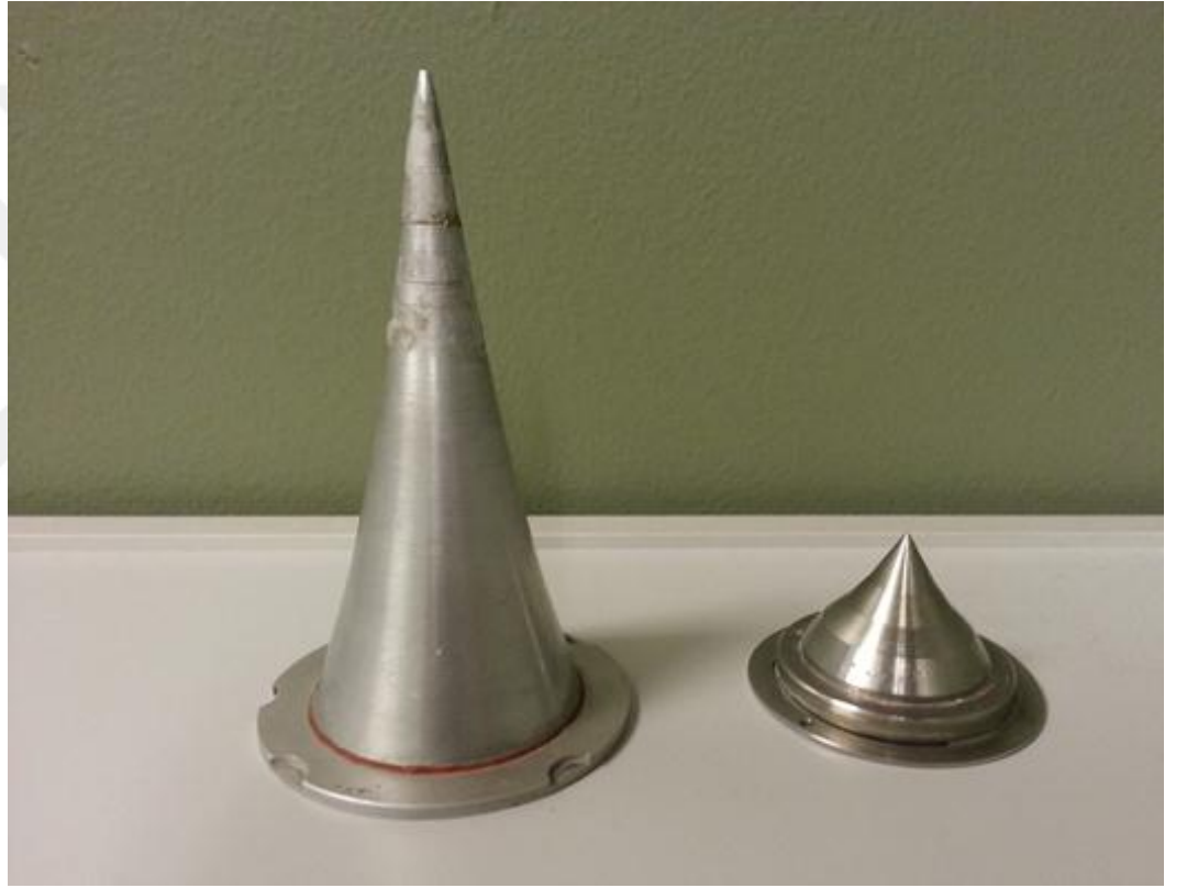
Resim 3.7. Medikal lineer hızlandırıcılarda kullanılan düzleştirici filtre
