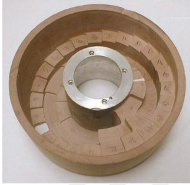
Resim 3.14. Pasif saçılma tekniğinde kullanılan menzil modölatör tekeri
