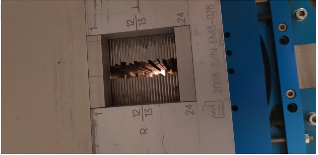
Resim 4.6. Gülhane Eğitim-Araştırma Hastanesi Radyasyon Onkolojisi Kliniğinde kullanılan Elekta Synergy lineer hızlandırıcı gantrisine monte edilen ÇYK yapraklarının açık ve kapalı halı
