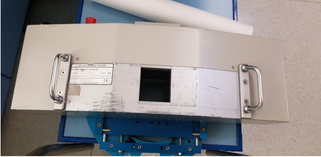
Resim 4.5. Gülhane Eğitim-Araştırma Hastanesi Radyasyon Onkolojisi Kliniğinde SRS/SBRT tedavilerinde kullanılan linak gantrisine monte edilebilen ÇYK
