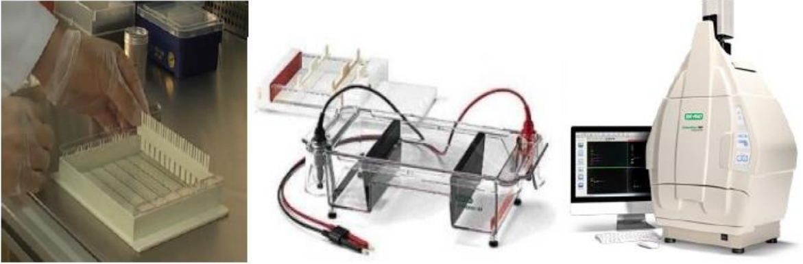
Şekil 3. 5. Agaroz jel analizinden genel görünüm. Agoroz jel kalıbı (solda), agoroz jel ünitesi (ortada), jel görüntüleme sistemi (sağda).
