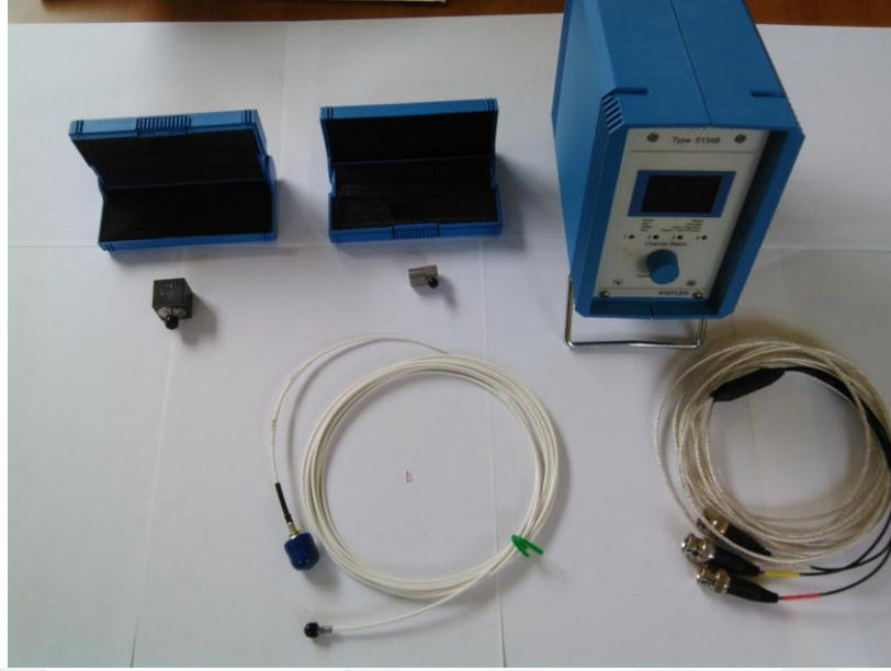
Fotoğraf 4.5. Kistler 5134B ile titreşim ölçüm ekipmanı.
