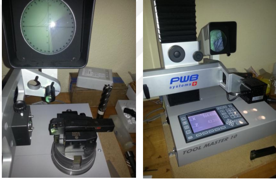
Fotoğraf 4.8. TOOL MASTER 10 ile aşınma ölçümü
