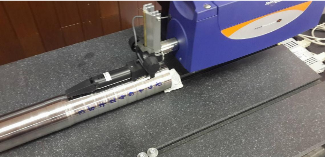
Fotoğraf 4.7. Talysurf, Taylor Hobson ile pürüzlülük ölçümü.
