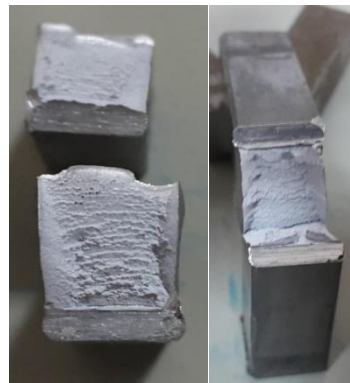
Fotoğraf 4.3. %3 polimerli ortam numunesi kırılma yüzeyleri
