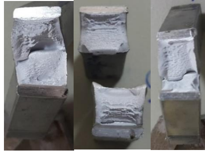
Fotoğraf 4.8. %8 polimerli ortam numunesi kırılma yüzeyleri
