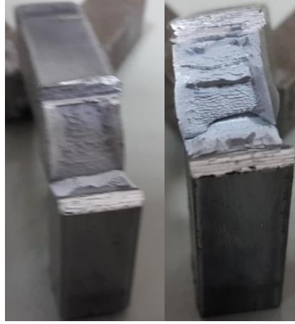
Fotoğraf 4.2. %2 polimerli ortam numunesi kırılma yüzeyleri
