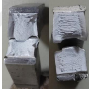
Fotoğraf 4.9. AA6082 Hava da soğutulmuş numunelerin çentik darbe deneyi sonrası kırılma yüzeyleri
