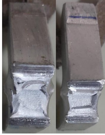
Fotoğraf 4.1. AA6082 T0 çentik darbe deneyi sonrası kırılma yüzeyleri
