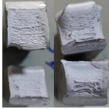
Fotoğraf 4.6. %6 polimerli ortam numunesi kırılma yüzeyleri
