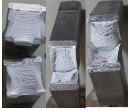
Fotoğraf 4.7. %7 polimerli ortam numunesi kırılma yüzeyleri
