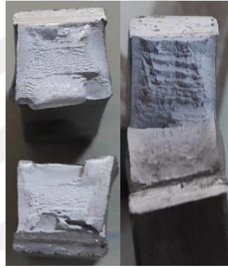
Fotoğraf 4.5. %5 polimerli ortam numunesi kırılma yüzeyleri
