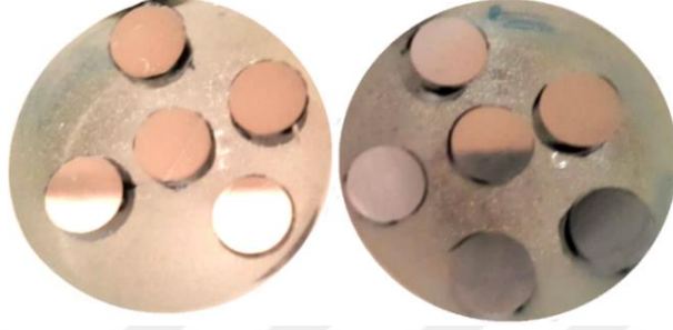
Fotoğraf 3.3. Kalıplanmış numune örneği (şekilde parlatılmış hali görülmektedir)
